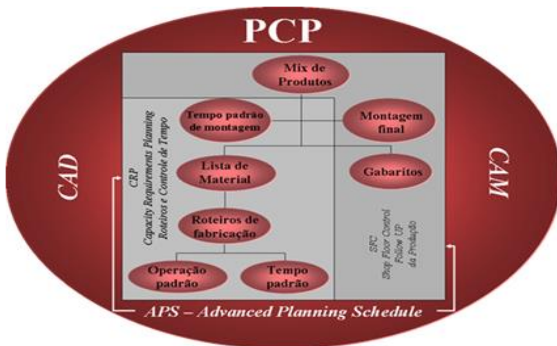
Figura 7 – Esquema de integração ambiente de projetos de novos produtos e componentes, processos de fabricação e programação da produção.
