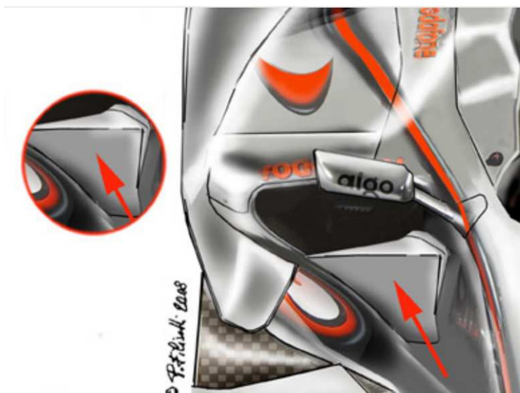
Figura 9: Carenagem adaptada no carro da McLaren para o GP da Bélgica
