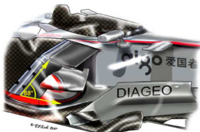
Figura 7: Layout de radiadores da equipe McLaren
