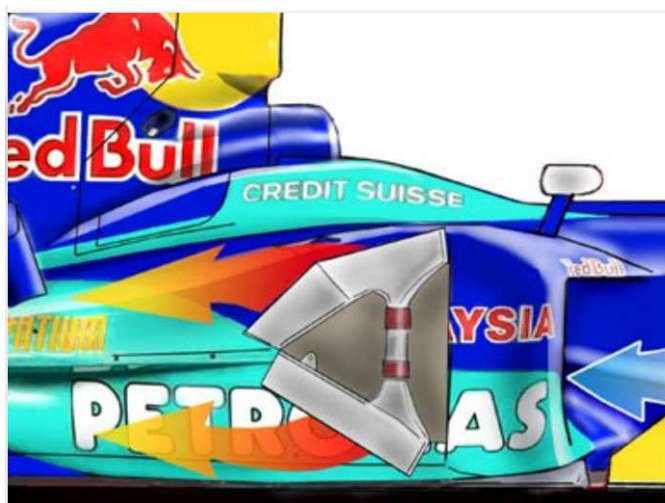
Figura 6: Configuração de radiadores da equipe Sauber em 2004.
