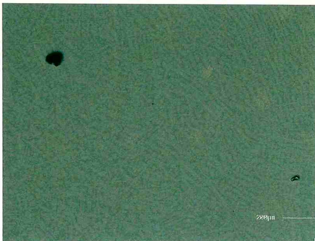
Figura 3.4. Micrografia do corpo fundido da liga Fe-30%Nb. Fase mais clara: Fase \epsilon (intermetálico \text{Fe}_2\text{Nb} ), Fase mais escura: Fe- \alpha . MEV-300X.
