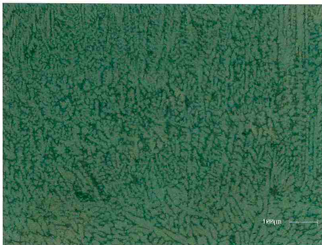
Figura 3.5. Micrografia da liga Fe-30%Nb após tratamento térmico. Fase mais clara: Fase \epsilon (intermetálico \text{Fe}_2\text{Nb} ), Fase mais escura: Fe- \alpha . MEV – 500X.
