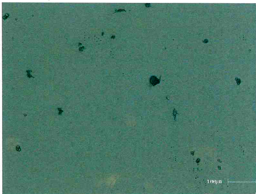
Figura 3.3. Micrografia da liga Fe-15%Nb após tratamento térmico. MEV – 500X.
