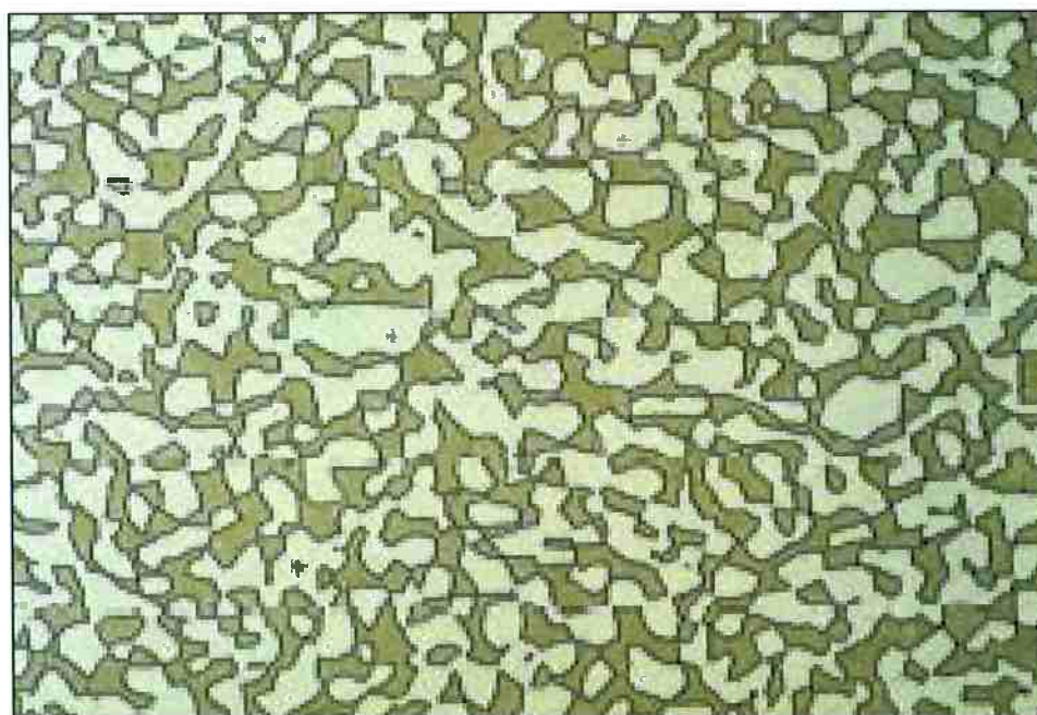
Figura 2.1: Estrutura de aço inoxidável duplex. Fase escura: Ferrita; Fase clara: Austenita [7] .
