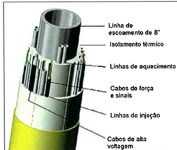
Figura 2.8: Diagrama de um tubo umbilical utilizado para extração de petróleo.
