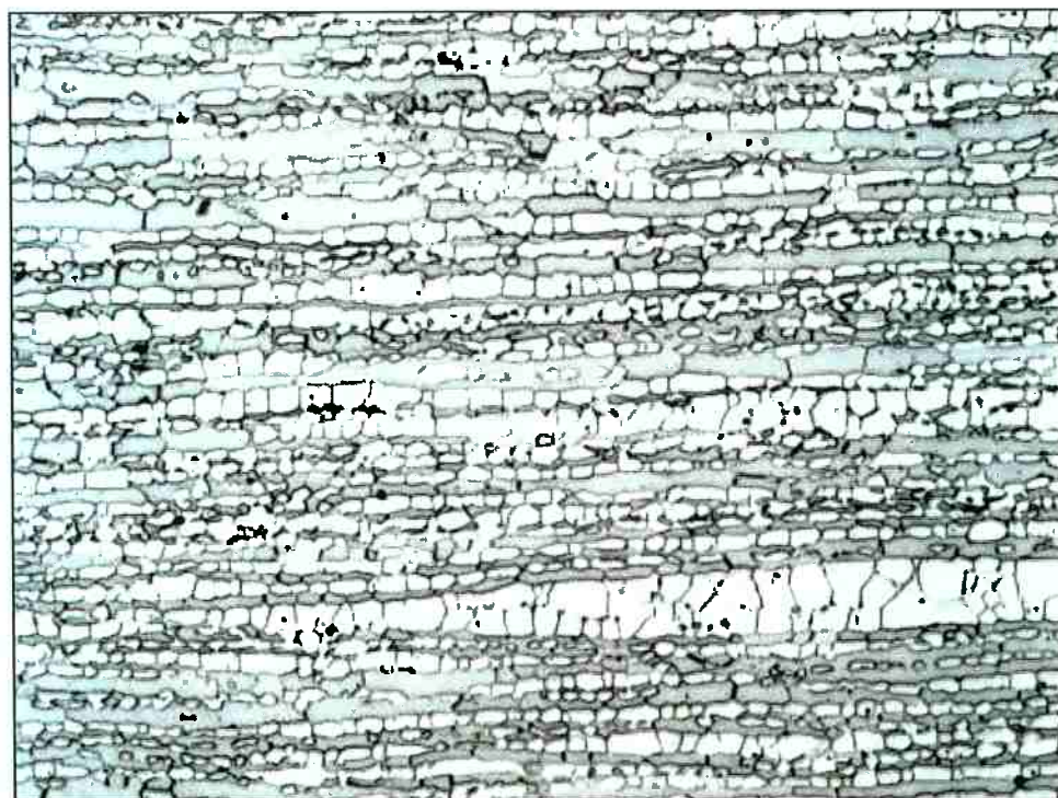
Figura 5.8: Metal de base do corpo de prova C2. Aumento 200x. Ataque em ácido oxálico. Nota-se contornos de grão mais escuros na interface austenita/ferrita.
