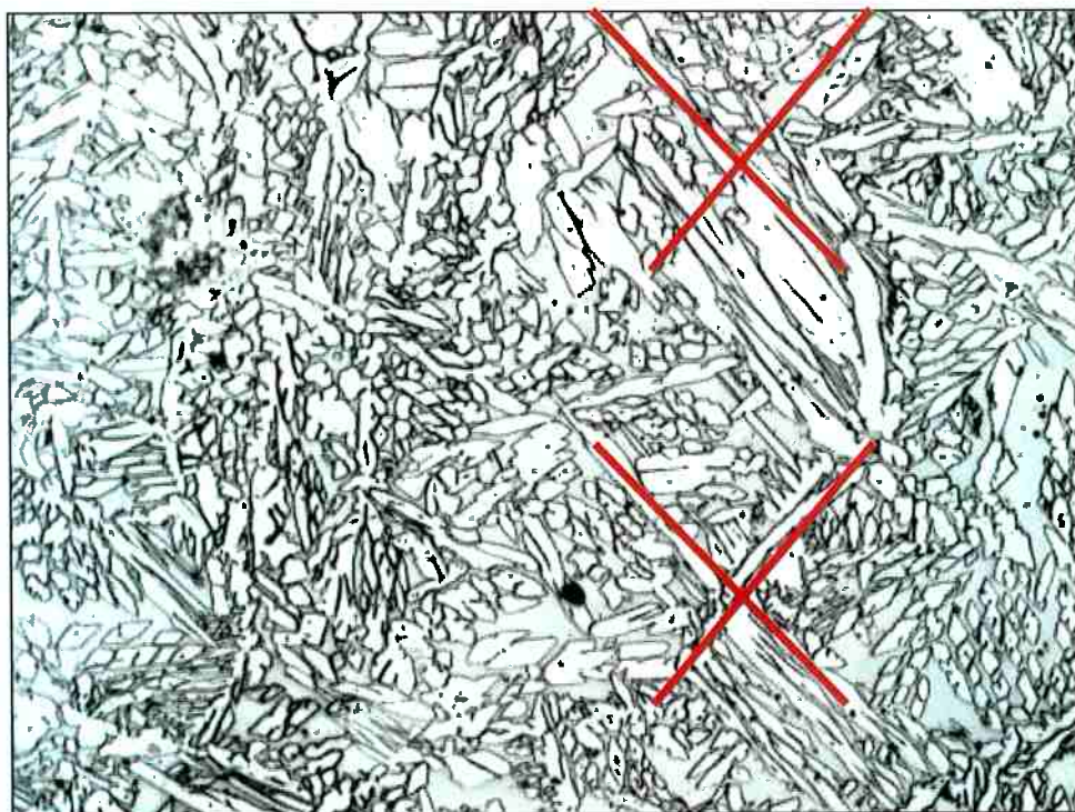
Figura 5.21. Zona fundida do corpo de prova C1. Aumento 200x. Ataque com ácido oxálico. As cruzes mostram o padrão de crescimento da austenita.
