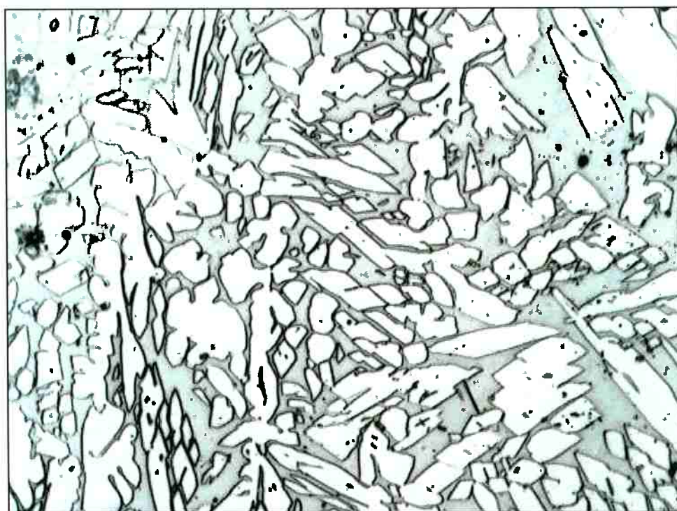
Figura 5.22: Zona fundida do corpo de prova C1. Aumento 500x. Ataque com ácido oxálico. Crescimento da austenita altera o formato da mesma, dando um formato losangular.
