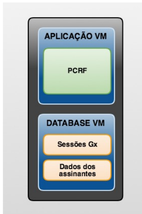
Figura 7: Representação de um hardware do projeto separado em duas máquinas virtuais distintas
