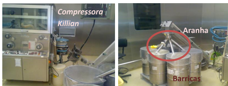
Figura 3.7 - Dispositivo de controle dos comprimidos e aranha para abastecimento das barricas
