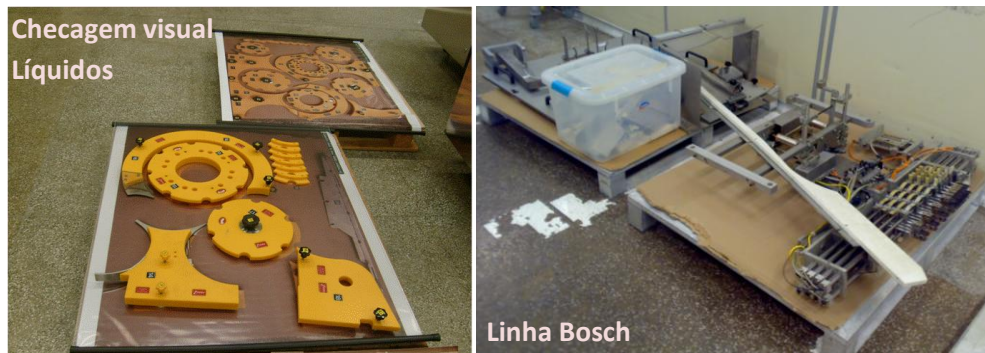
Figura 6.20 - Técnica de checagem visual já aplicada à linha de líquidos e situação atual na Bosch
