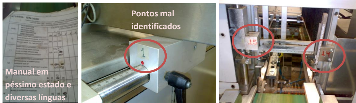
Figura 6.17 - Situação antiga para ajuste da encaixotadeira, com lista antiga e numeração deficiente
