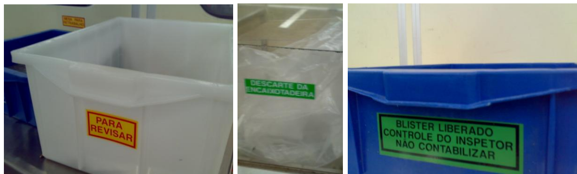
Figura 6.10 - Identificação "estilo semáforo" da linha Bosch
