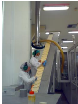
Figura 6.15 - Limpeza da esteira do elevador
