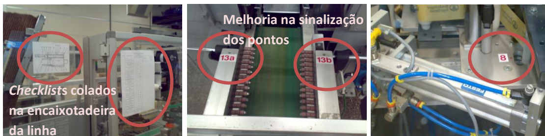
Figura 6.18 - Nova disposição de checklist e identificação dos pontos de ajuste
