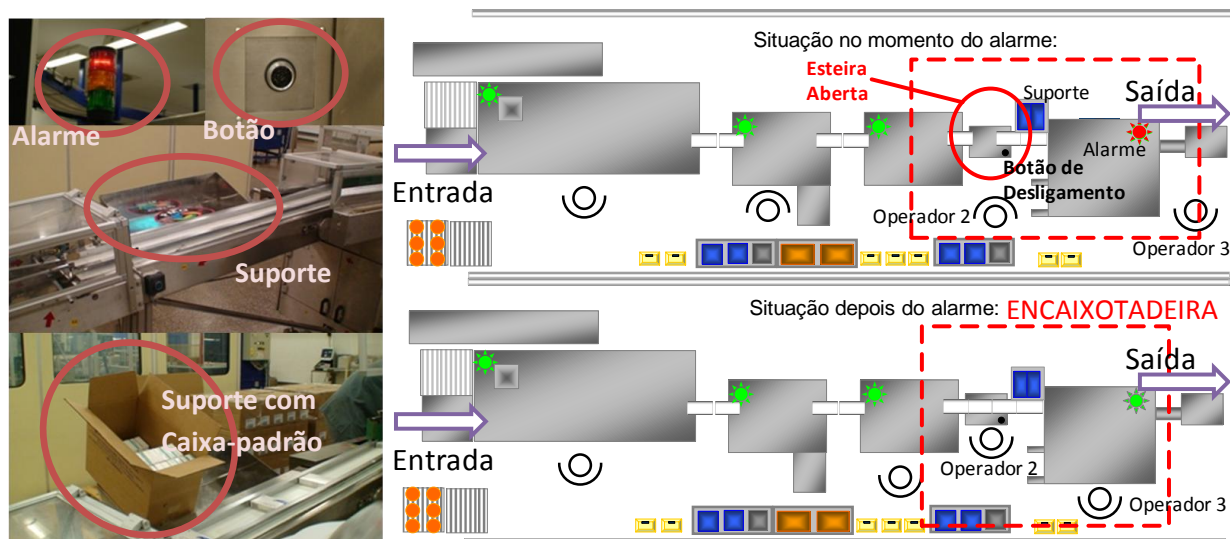
Figura 6.22 – Alarme, sinalização e suporte de caixa padrão para desenvolvimento do trabalho em equipe na parada da encaixotadeira
