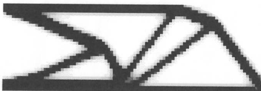
Figura 25 Estrutura obtida para o Caso 1, porém com restrição de quarenta por cento do volume, e o método da continuação ativo. A função objetivo tem o valor final 16.652338.
