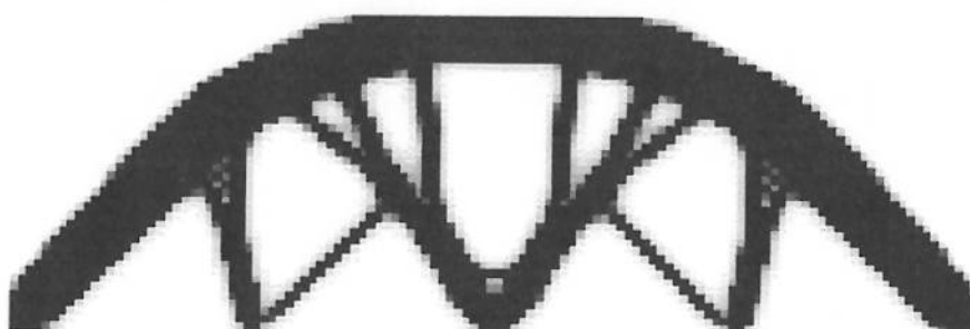
Figura 27 Estrutura obtida para o Caso 3, porém com restrição de quarenta por cento do volume, e o método da continuação ativo. A função objetivo tem o valor final 10.823697 (para apenas uma metade).
