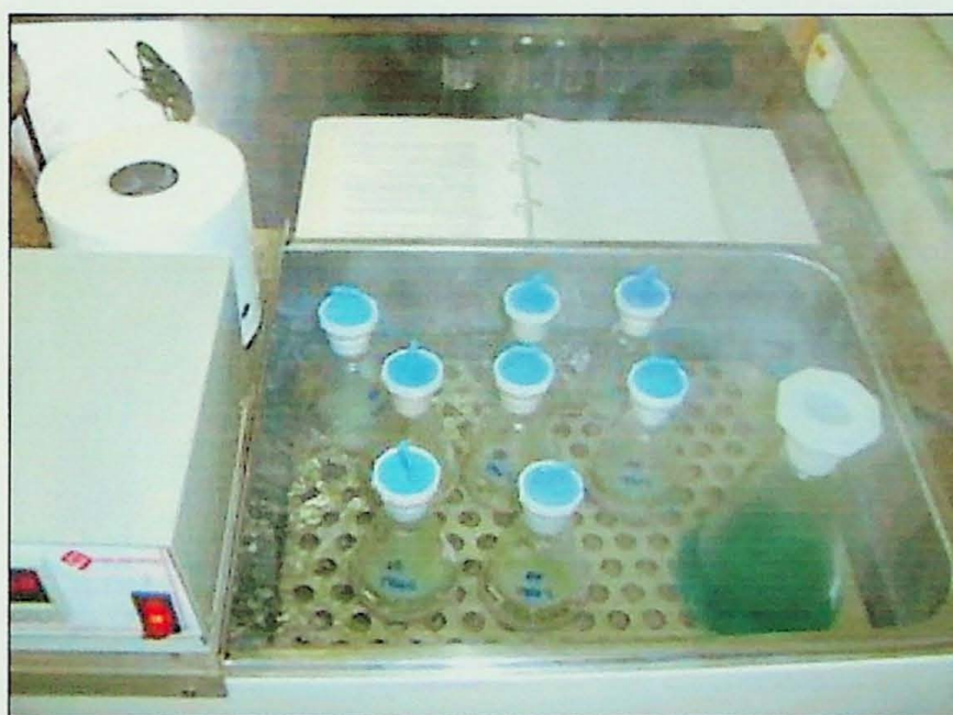
Foto 6 – Banheira com Água a 65°C onde são aquecidos os frascos e realizado a dissolução parcial.
