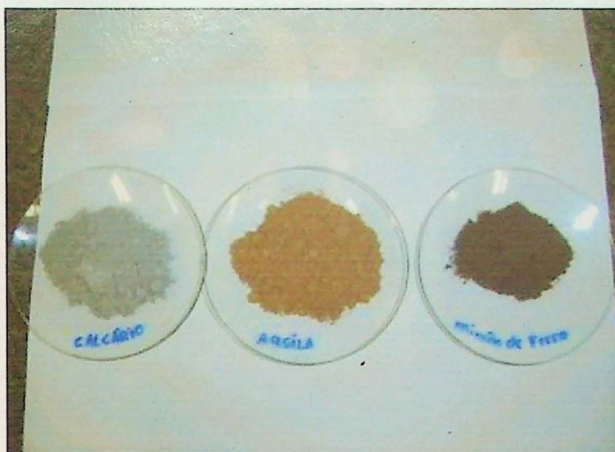
Foto 1 – Matérias-Primas Tradicionais Preparadas para Fabricação do Clínquer Portland.
