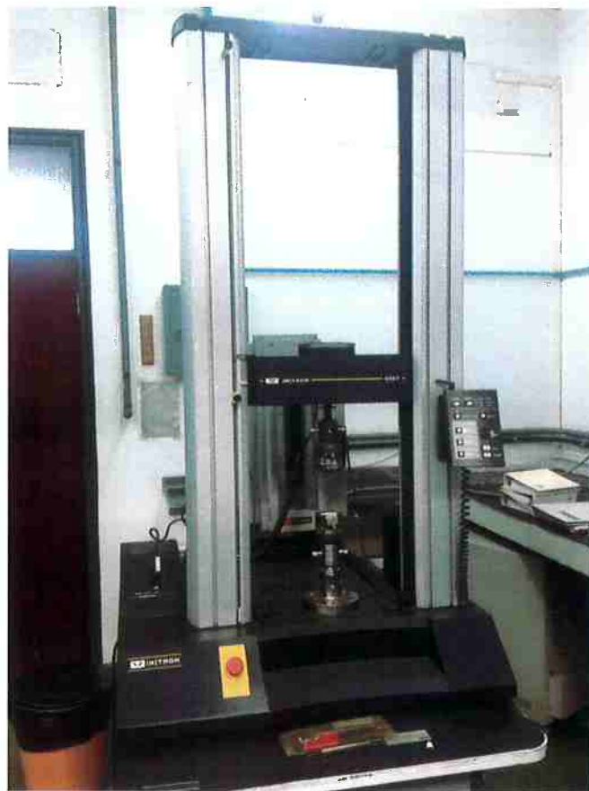
Figura 11 - Equipamento utilizado nos ensaios de tração.
