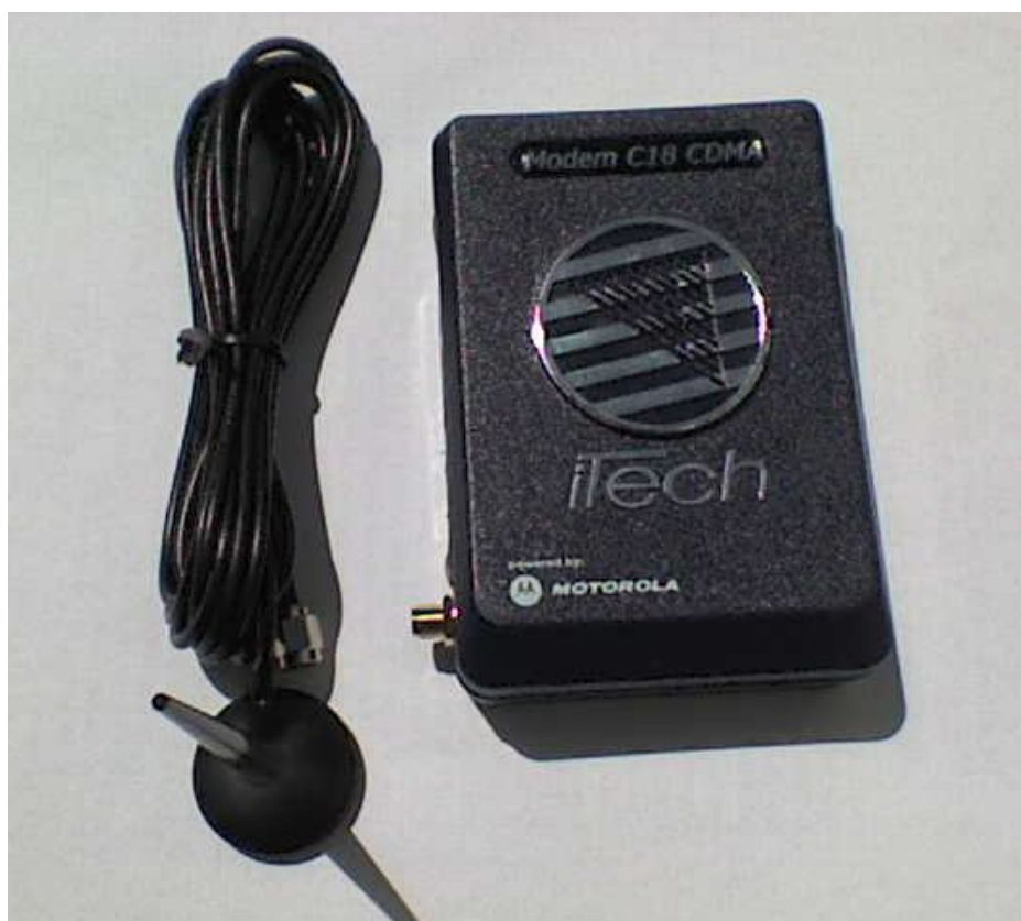
Figura 4.3 – Módulo de transmissão CDMA C18 Motorola
