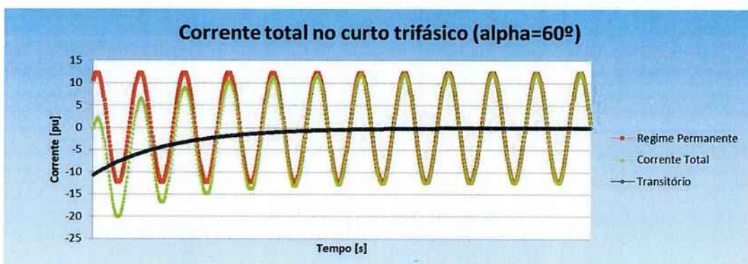
Figura 22 - Forma de onda da corrente de curto trifásico ( \alpha=60^\circ )
