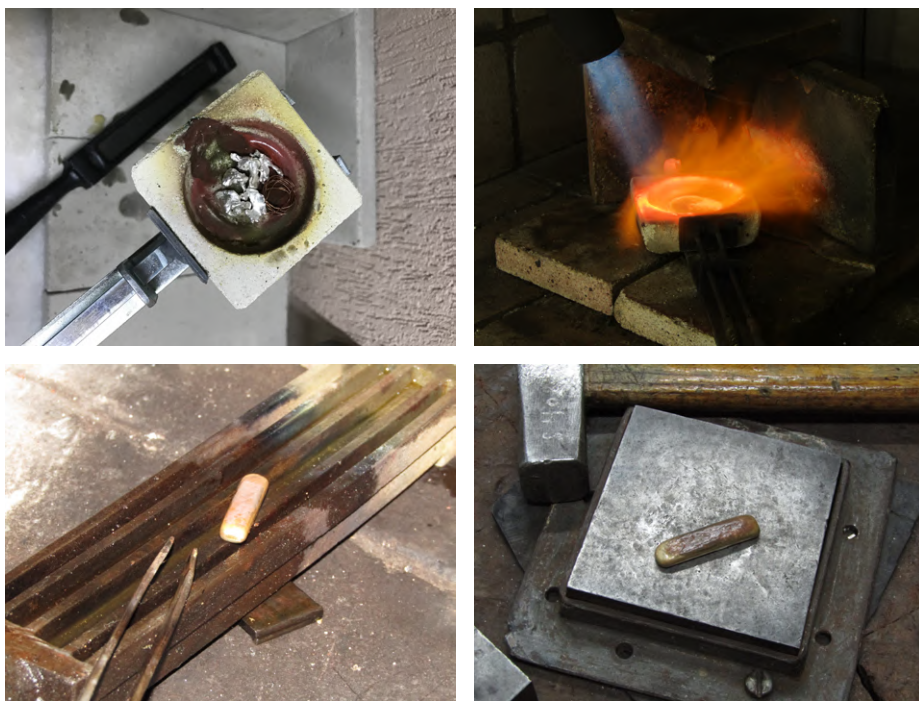
Figuras 8 a 11 - Processo de fundição na joalheria. Fonte: autor.
