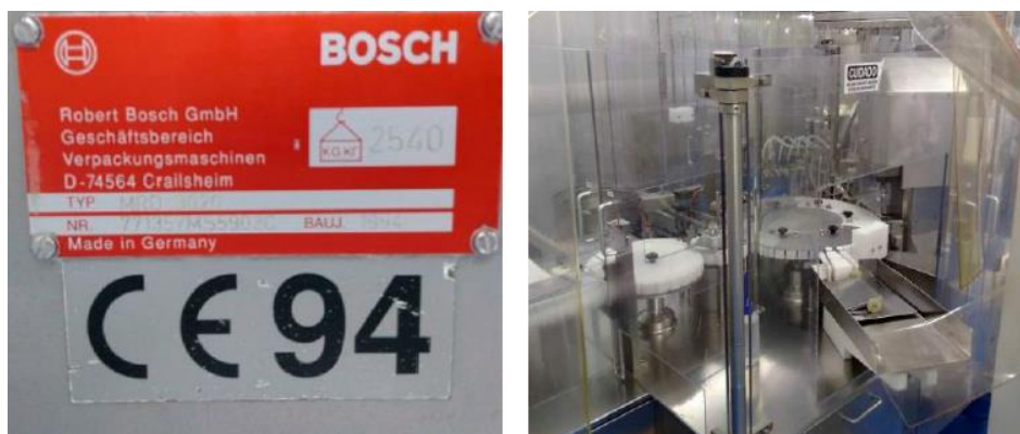
Figura 14 - Placa de identificação e imagem frontal da máquina envasadora 2 (EC02)
