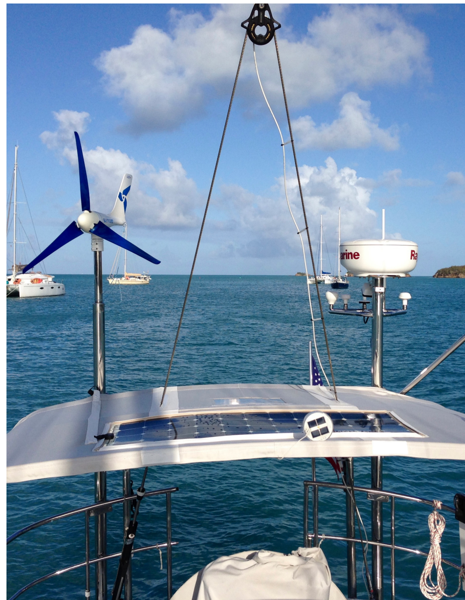
Figura 24: Instalação de geradores eólicos e solares apoiados no cockpit.
