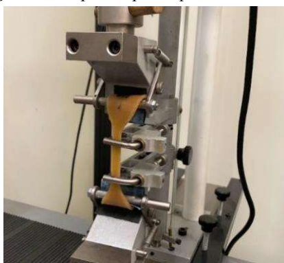
Figura 29: Detalhe da fixação dos corpos de prova para o ensaio de tração com extensômetro
