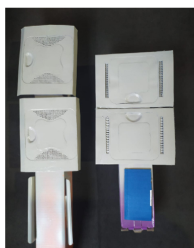
Figuras 149, 150: Compilação de folhas de impressão com a planificação das diversas peças usadas para montar a miniatura em escala 1:3 do gabinete. Fases diversas de produção manual do modelo físico: cortes, dobras e vincos, colagem, furos/rebaixos/relevos, pré-montagem, pintura. Fonte: autoral.
