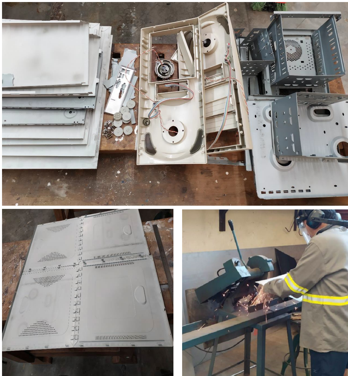
Figuras 119, 120, 121: Gabinete desmontado e separado em categorias, chapas retiradas do CPU para aproveitamento, processo de remoção de elementos não-desejados das bordas
