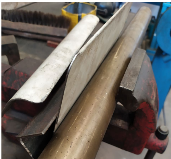
Figuras 122, 123, 124, 125: dobra com dobradeira hidráulica manual, chapa lateral dobrada, conformação manual da chapa de topo (alças), alças conformadas. Fonte: autoral.
