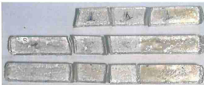
Figura 41 - Corpos de prova A i1 , A i2 e A i3 , respectivamente, após ensaio de impacto Charpy. (Fonte: acervo pessoal)
