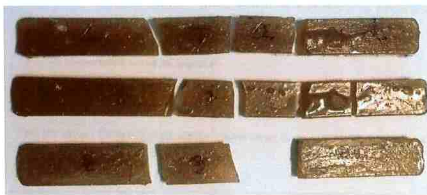
Figura 42 - Corpos de prova B 11 , B 12 e B 13 , respectivamente, após ensaio de impacto Charpy. (Fonte: acervo pessoal)
