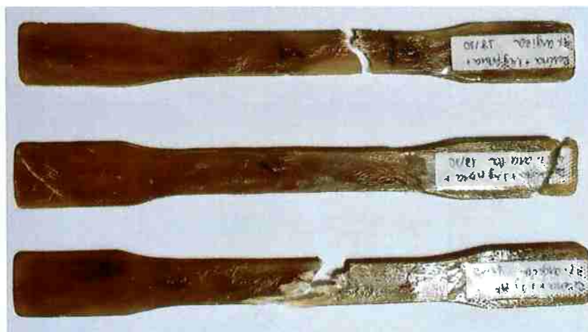
Figura 40 - Corpos de prova DT 1 , DT 2 e DT 3 , respectivamente, após ensaio de tração. (Fonte: acervo pessoal)
