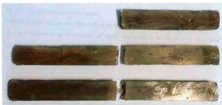
Figura 44 - Corpos de prova D 11 , D 12 e D 13 , respectivamente, após ensaio de impacto Charpy. (Fonte: acervo pessoal)
