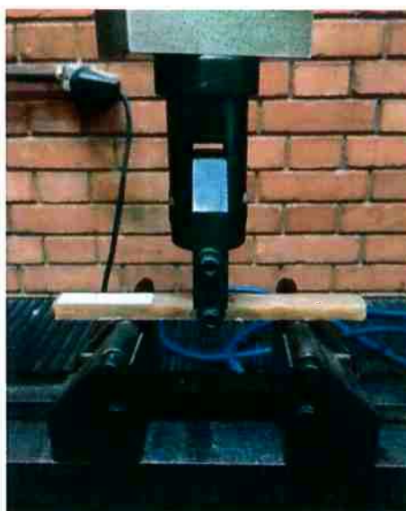
Figura 22 – Ensaio de flexão em três pontos realizado sobre o corpo de prova C_{F3} , composto de resina de poliéster e 20% em volume de fibras de carauá. (Fonte: acervo pessoal)
