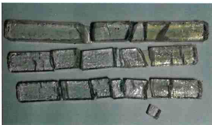
Figura 28 – Corpos de prova A F1 , A F2 e A F3 , respectivamente, após ensaio de flexão em três pontos.
