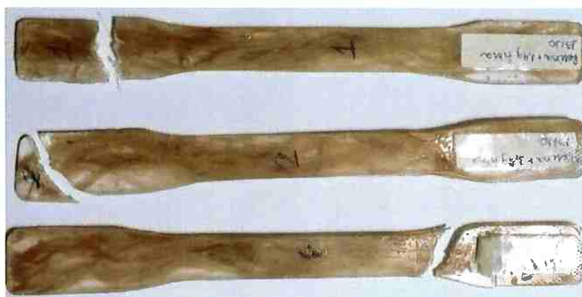
Figura 38 - Corpos de prova C T1 , C T2 e C T3 , respectivamente, após ensaio de tração. (Fonte: acervo pessoal)
