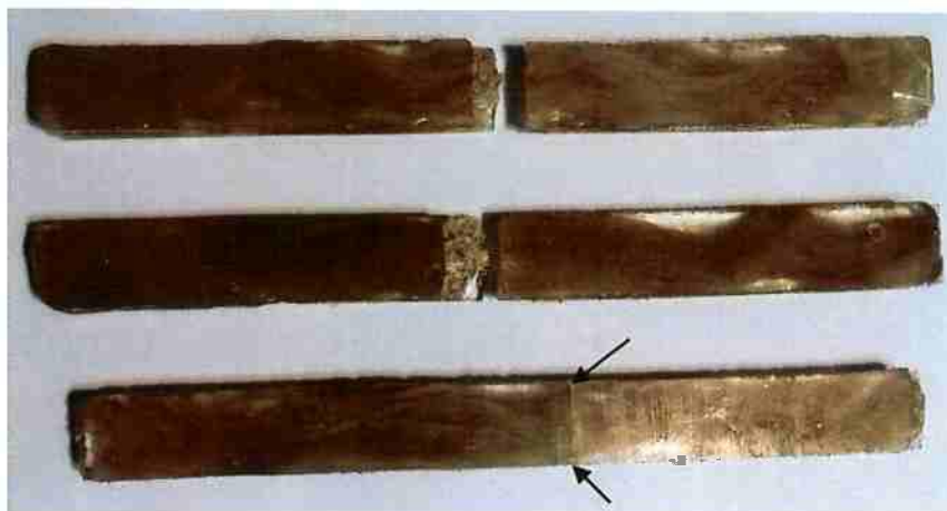
Figura 30 – Corpos de prova C_{F1} , C_{F2} e C_{F3} , respectivamente, após ensaio de flexão em três pontos.
