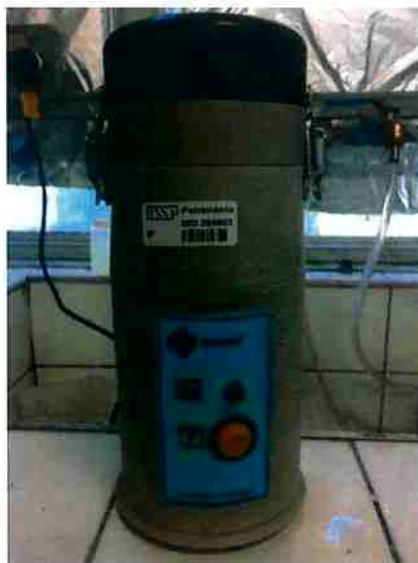
Figura 15 – Moinho analítico Quimis Q2998A21, utilizado na moagem da argila organofílica (Fonte: acervo pessoal)
