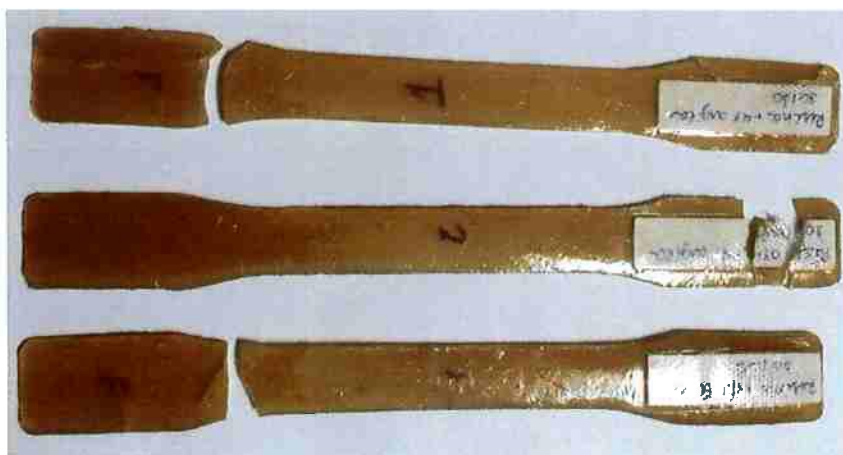
Figura 36 - Corpos de prova B_{T1} , B_{T2} e B_{T3} , respectivamente, após ensaio de tração. (Fonte: acervo pessoal)
