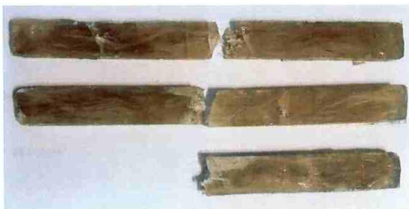
Figura 43 - Corpos de prova C 11 , C 12 e C 13 , respectivamente, após ensaio de impacto Charpy. (Fonte: acervo pessoal)
