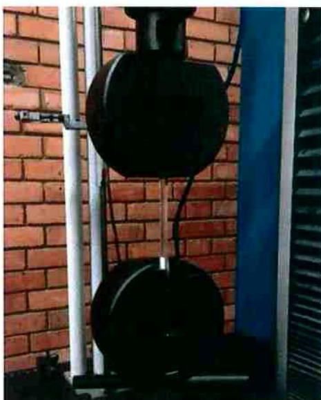
Figura 23 – Ensaio de tração realizado sobre corpo de prova A_{T2} , composto de resina de poliéster pura. (Fonte: acervo pessoal)
