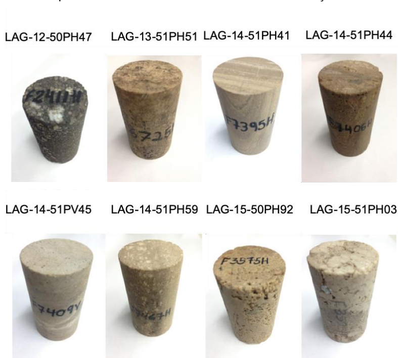
Figura 12 - Exemplos de amostras de plugues de rocha carbonática utilizada como fonte de dados para desenvolvimento do modelo de simulação.
