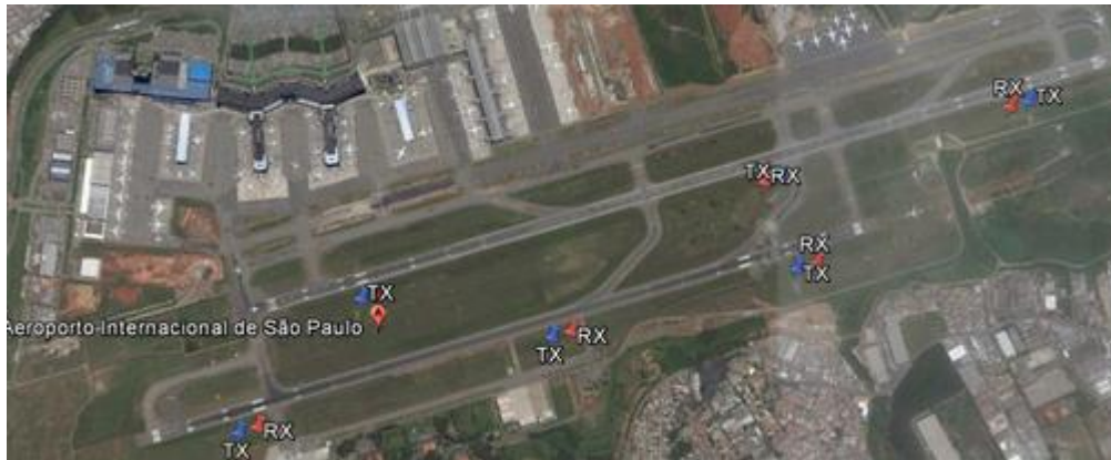
Figura 4 - Posicionamento dos transmissômetros e sensores de tempo presente no Aeroporto de Guarulhos (tx são transmissores e rx os receptores, que medem a transmissividade).
