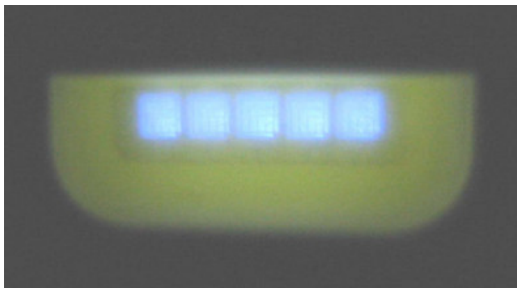
Figura 5.48: Distribuição luminosa de um LED com 5 chips. [3]
