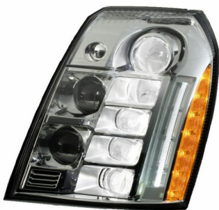
Fig. 5.21: Farol do Cadillac Escalade Platinum 2008 com o fecho baixo aceso
