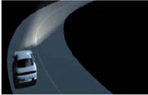
Figura 5.12: Iluminação flexível dinâmica
