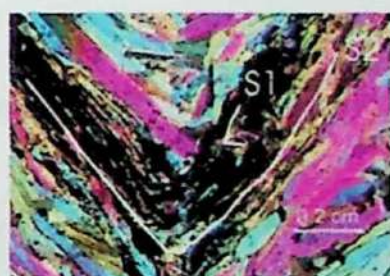
Foto 21- Níveis lepidoblásticos a Ms e alguma Grafita da S2 dobrados na S3. Observa-se arcos poligonais da S1 dentro dos níveis dobrados. É a mesma rocha da Foto 19.
