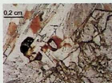
Foto 8- Sil prismática e idioblástica em paragênese com Grt porfiroblástica pós-S2. A Grt cresceu englobando a Sil da matriz. Lâmina de Pl-Grt-Bt-Ms-Sil-Qtz Xisto
