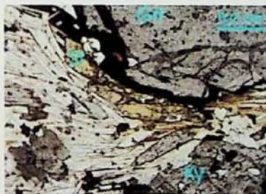
Foto 19- Cristais de St subidioblásticos geminados pós-S2 em torno de porfiroblasto de Grt. Rocha: Qtz-St-Grt-Ky-Ms Xisto.
