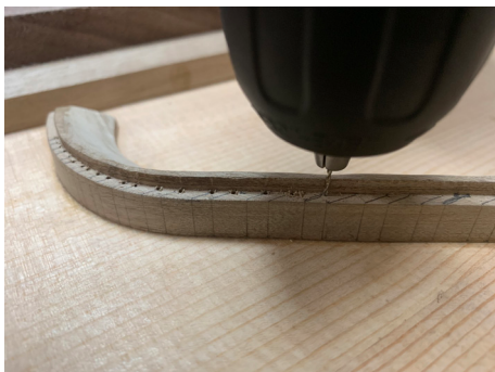
Foto 38. Os furos no cavalete foram feito com uma broca de 1 mm.
