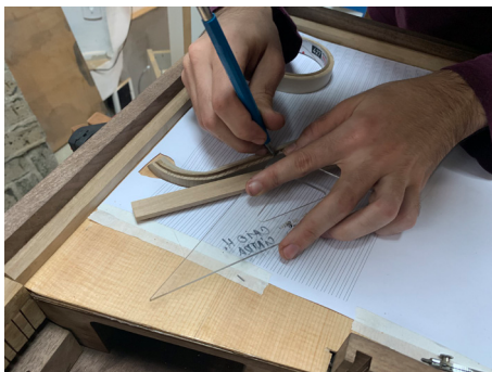
Foto 36. A marcação da posição dos pinos do cavalete foi feita com auxílio de um esquadro.
