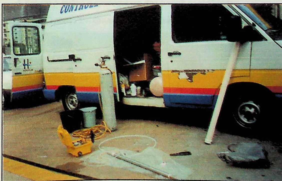
Figura 7 - Equipamentos para amostragem com baixa vazão utilizados no Posto Treze Cruz de Malta
