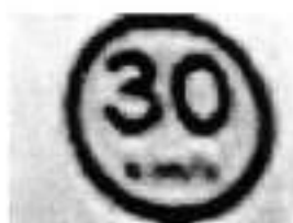
Fig. 36 - Resultado da normalização do histograma, sem saturação.
