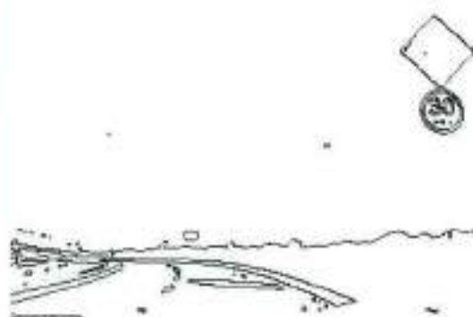
Fig. 9 - Pixels vermelhos identificados pelo critério de limiar em HSI, seguida de detecção de borda.
