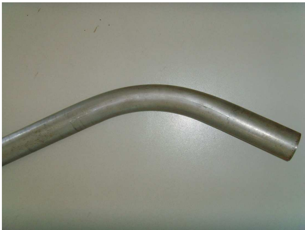
Figura 25 - Dobra do tubo da estrutura após a modificação do equipamento
