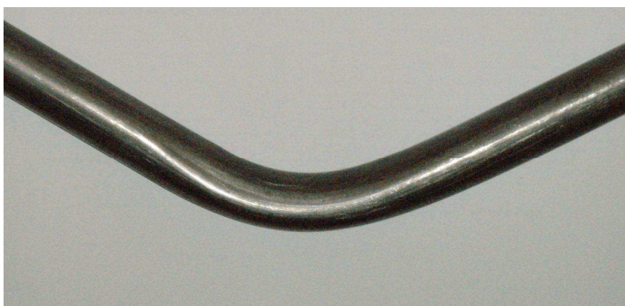
Figura 28 - Dobra do tubo da suspensão preenchido com areia
