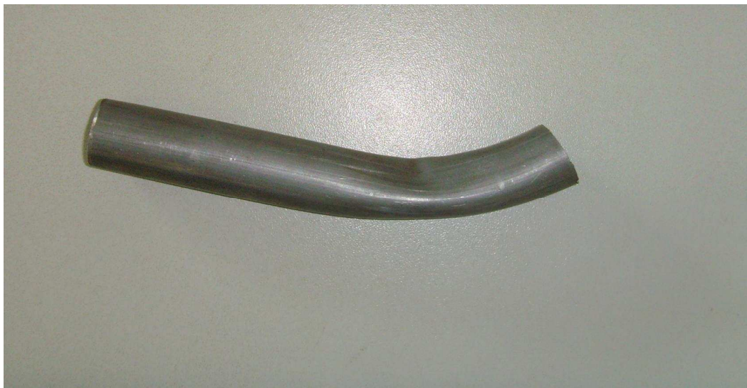
Figura 27 - Dobra do tubo da suspensão após modificação no equipamento
