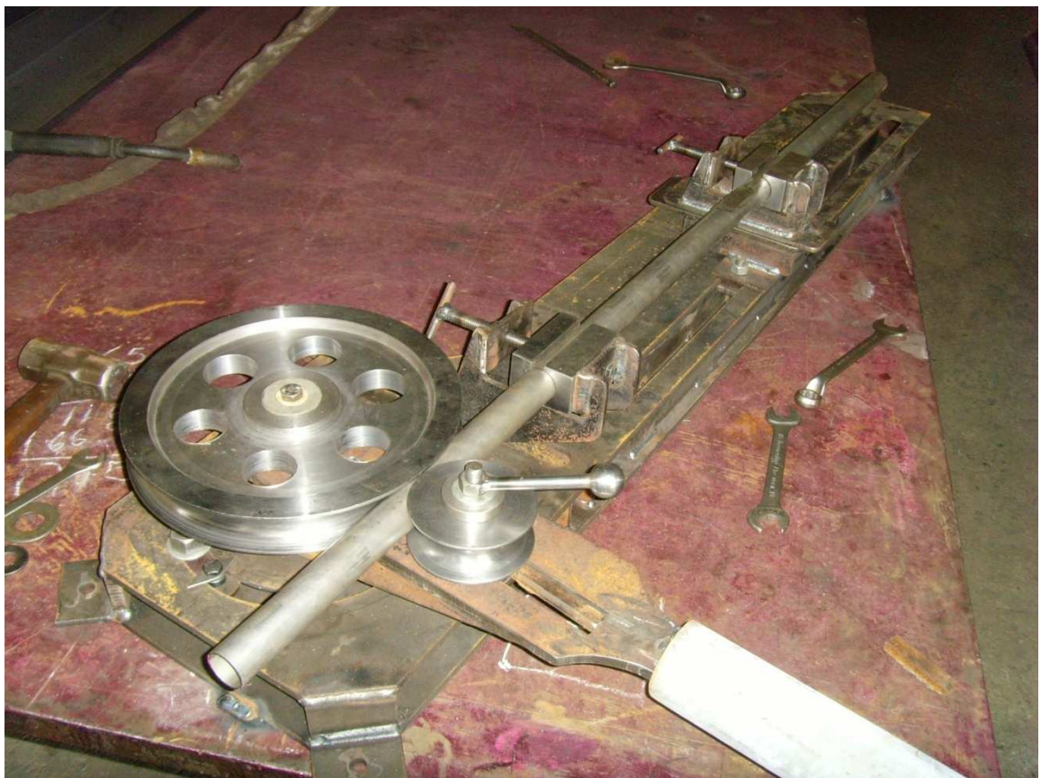
Figura 22 - Posicionamento do tubo
