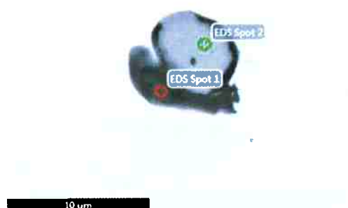
Figura 23: Análise de EDS correspondente à Figura 22-B. Foram analisados dois pontos da inclusão.
