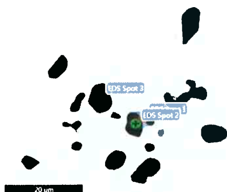
Figura 24: Análise de EDS correspondente à Figura 22-A. Foram analisados três pontos da inclusão.
