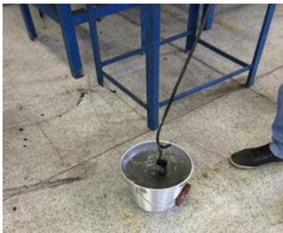
Figura 13 – Amostras sendo resfriadas no fluido após austenitização
