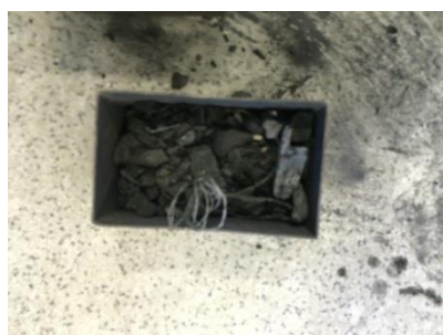
Figura 10a – Amostras cobertas com carvão em caixa metálica
