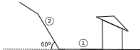
Figura 11 - Esquemática de situação real para explicar necessidade de uso de declividade máxima durante o trabalho. Onde 1 representa uma superfície plana e 2 um talude natural ou de corte com declividade alta.
