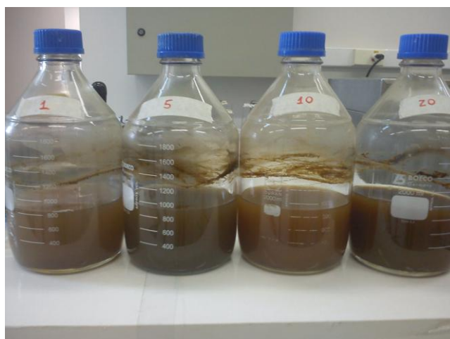
Figura 5.17 - Reatores em batelada da “Etapa 2” ao utilizar xilose como fonte de carbono e ureia como fonte de nitrogênio.
