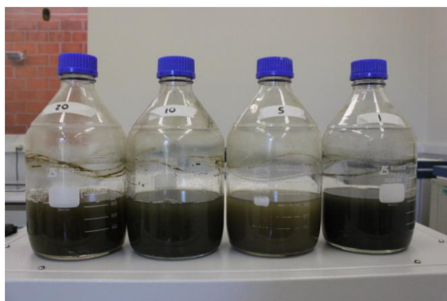
Figura 5.2 - Reatores em batelada da “Etapa 1” ao utilizar licor de pentoses como fonte de carbono.
