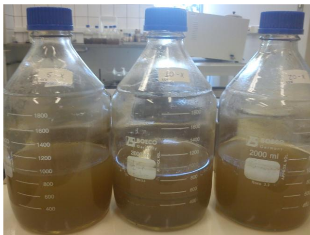
Figura 5.1 - Reatores em batelada da “Etapa 1” ao utilizar xilose como fonte de carbono.
