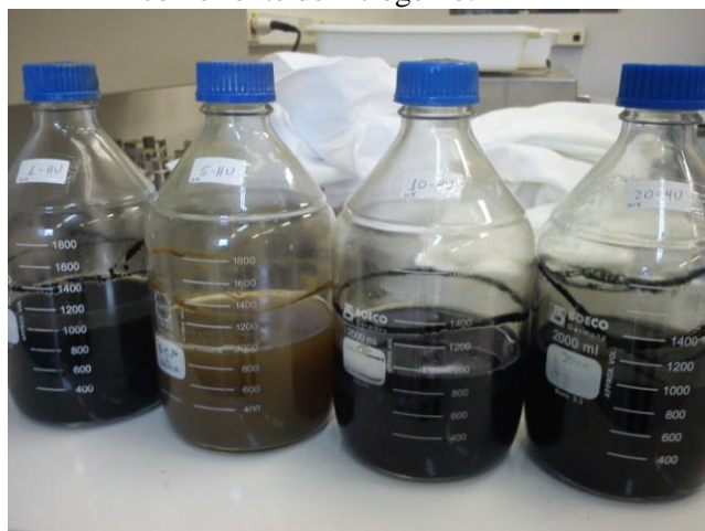
Figura 5.18 - Reatores em batelada da “Etapa 2” ao utilizar licor de pentoses como fonte de carbono e ureia como fonte de nitrogênio.
