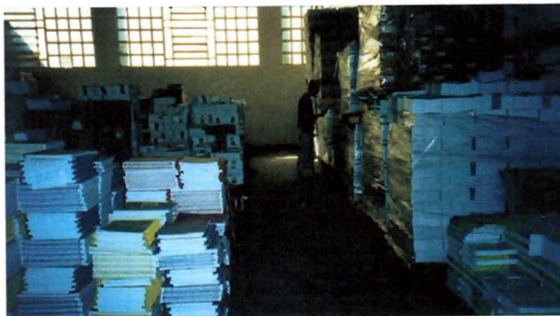
Figura 20 Aqui observamos os corredores laterais, onde não é possível a entrada e a manobra de uma empilhadeira.
