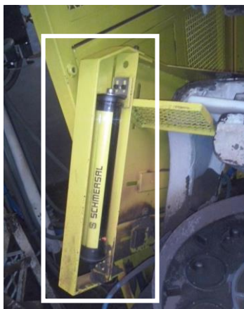
Figura 47: Cortina de Luz de Segurança Categoria 4 com Grau de Proteção IP69K.
