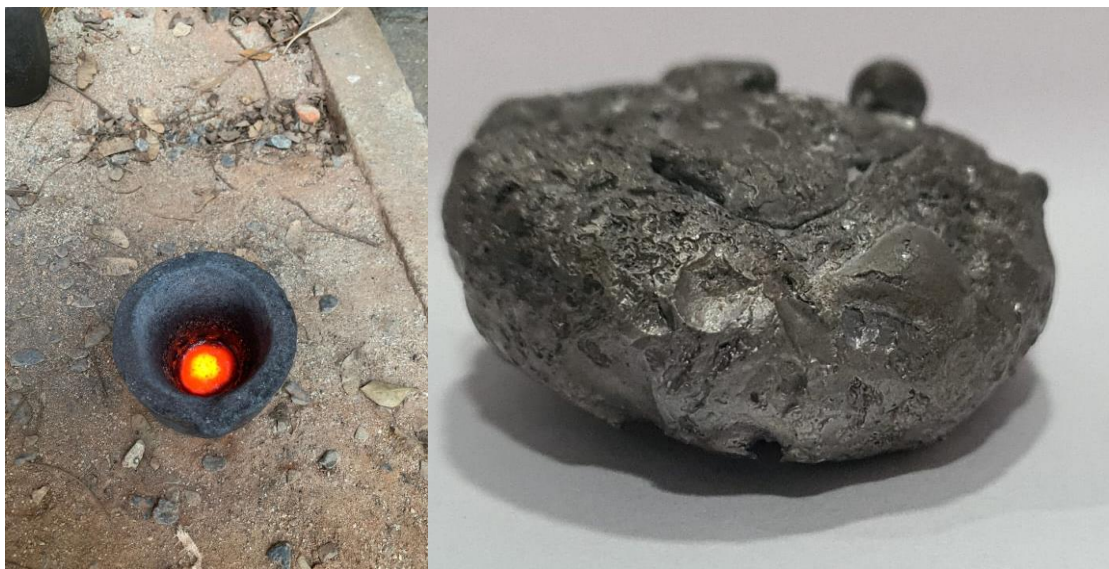
Figura 27: (a) Amostra durante processo de aluminotermia. (b) Amostra de Ferro após a reação. (Acervo pessoal, 2022).
