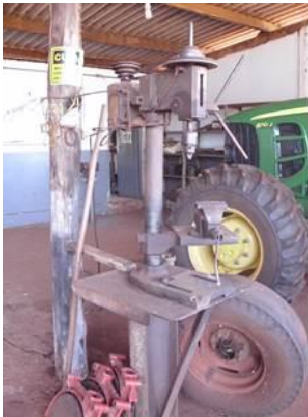
Figura 22 - Furadeira sem proteção de correias na FEP Vegetal. Fonte: Arquivo pessoal.
