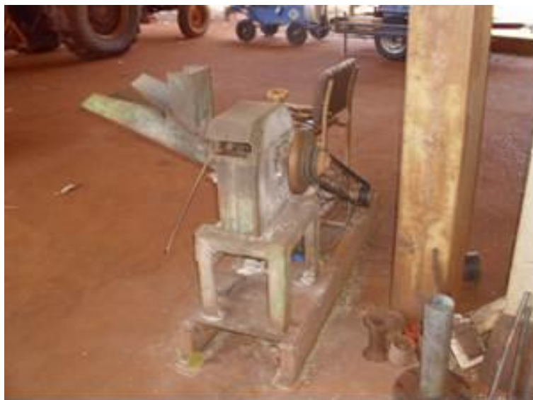
Figura 24 - Triturador sem proteção na FEP Vegetal.
