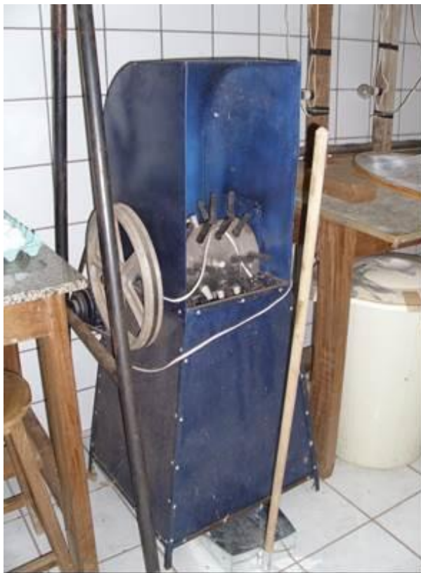
Figura 33 - Depenador de aves sem proteção, no Prédio da Avicultura, na FEP Horticultura / Zootecnia.
