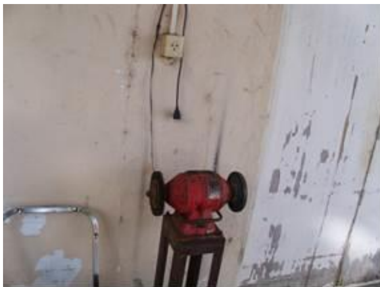
Figura 41 - Esmeril sem proteção na FEP Parques.
