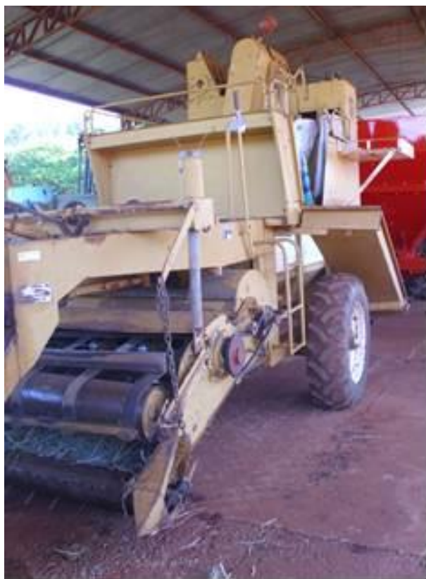
Figura 23 - Batedeira de grãos sem proteções na FEP Vegetal. Fonte: Arquivo pessoal.
