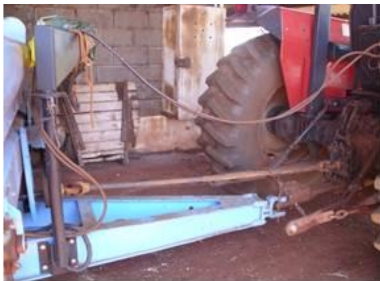
Figura 2 - Eixo cardan sem proteção do distribuidor de ração na FEP Animal. Fonte: Arquivo pessoal.
