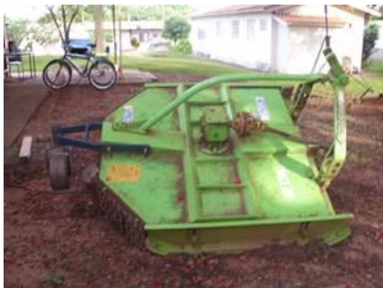
Figura 40 - Roçadeira sem proteção do eixo cardan na FEP Parques. Fonte: Arquivo pessoal.
