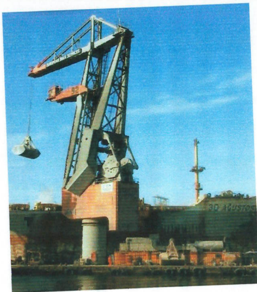
Fig.. 20 – Visão da operação de Guindastes de 36 tons, -- Terminal E.B.S.
