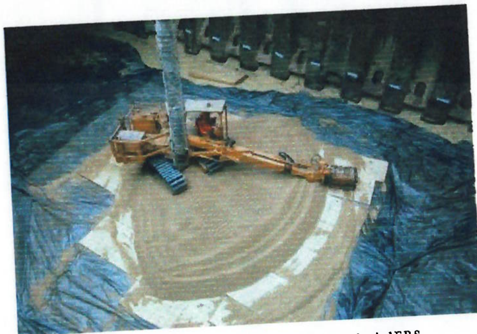
Fig.. 12 – Visão da separação do produto por um sugador de grande porte – Terminal E.B.S.
