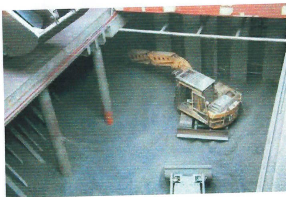
Fig.. 23 – Visão da máquina de recheio no porão do navio – Terminal E.B.S.
