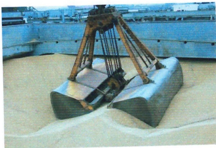
Fig.. 17 – Visão do Grab operando no porão de carga – Terminal E.B.S.
