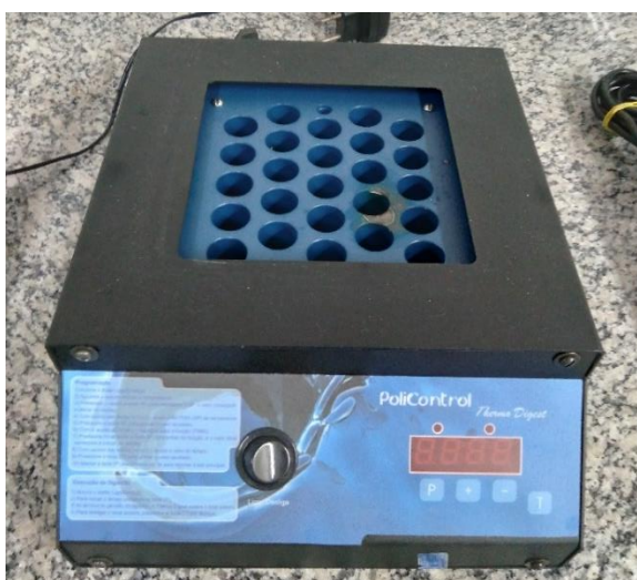
Figura 22 Bloco digestor utilizado para determinação de DQO.
