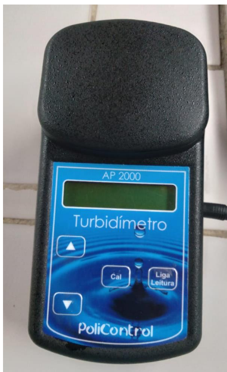
Figura 19 Turbidímetro utilizado nas medições de turbidez.
