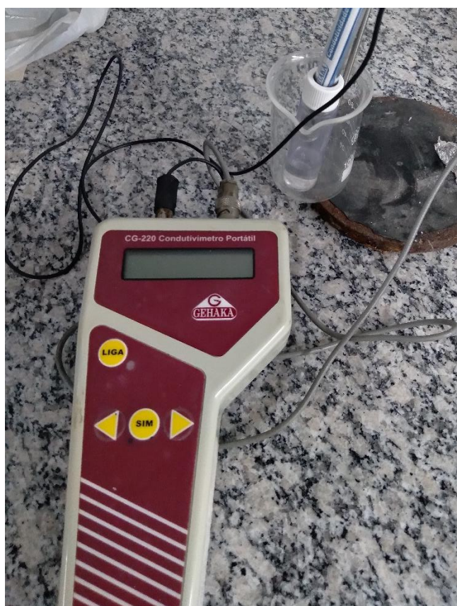
Figura 20 Condutivímetro utilizado nas medições de condutividade.
