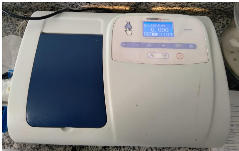
Figura 21 Espectrofotômetro utilizado nas medições de UV-Vis 254nm.
