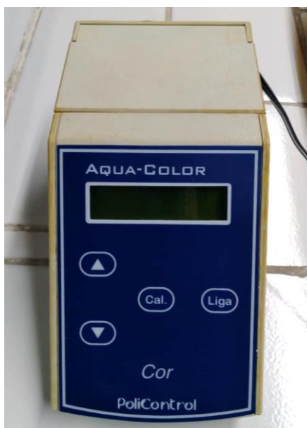
Figura 18 Fotocolorímetro utilizado nas medições de cor.
