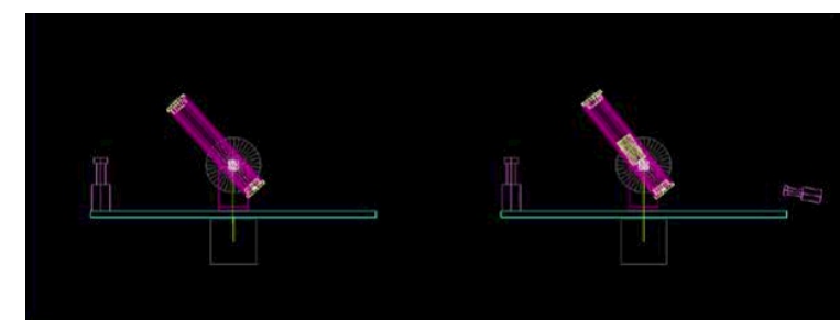
Fig. 15 (acima): Motor de movimento recíproco baseado em um solenóide e ímãs permanentes - Berto Aussems, YouTube
