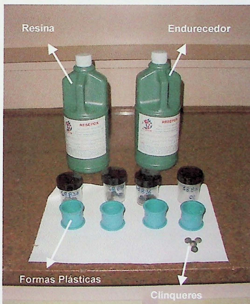
FOTO 6: Resina a base de epoxi e Endurecedor. Detalhe da disposição dos clínqueres nas formas plásticas para confecção das seções polidas.
