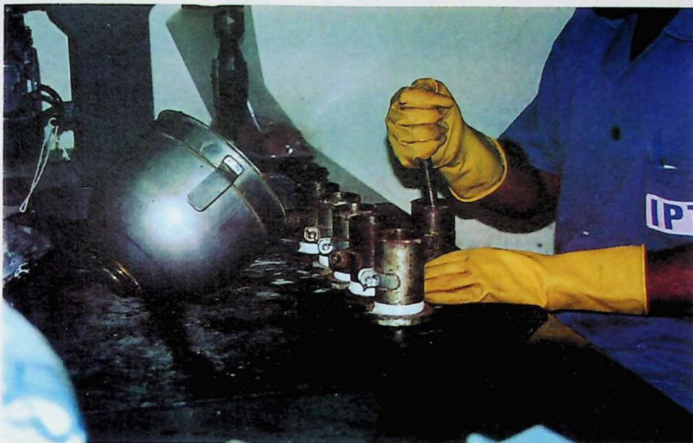
Foto 15. Moldagem dos corpos de prova. Preenchimento dos moldes com argamassa e compactação com soquete metálico.
