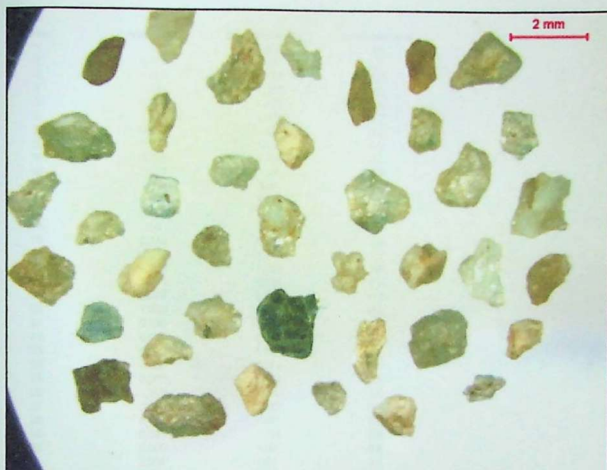
Grãos de areia de leito de rio representativos da malha #28 (0,6mm)
