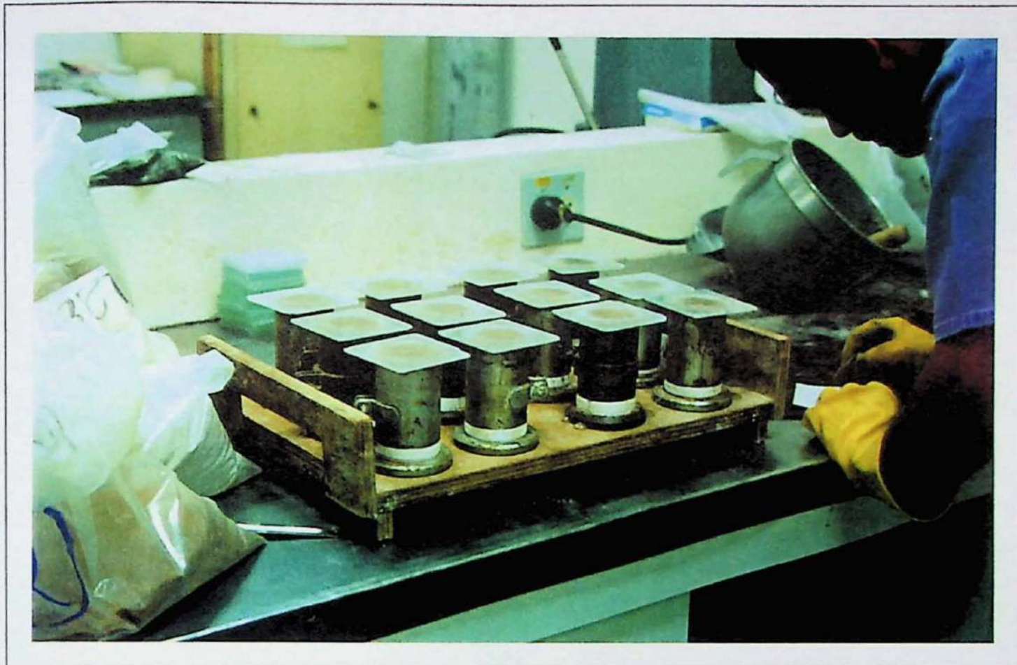
Foto 17. Moldagem dos corpos de prova. Colocação das placas de vidro sobre cada molde para preservação de umidade e regularidade da face superior dos corpos de prova.
