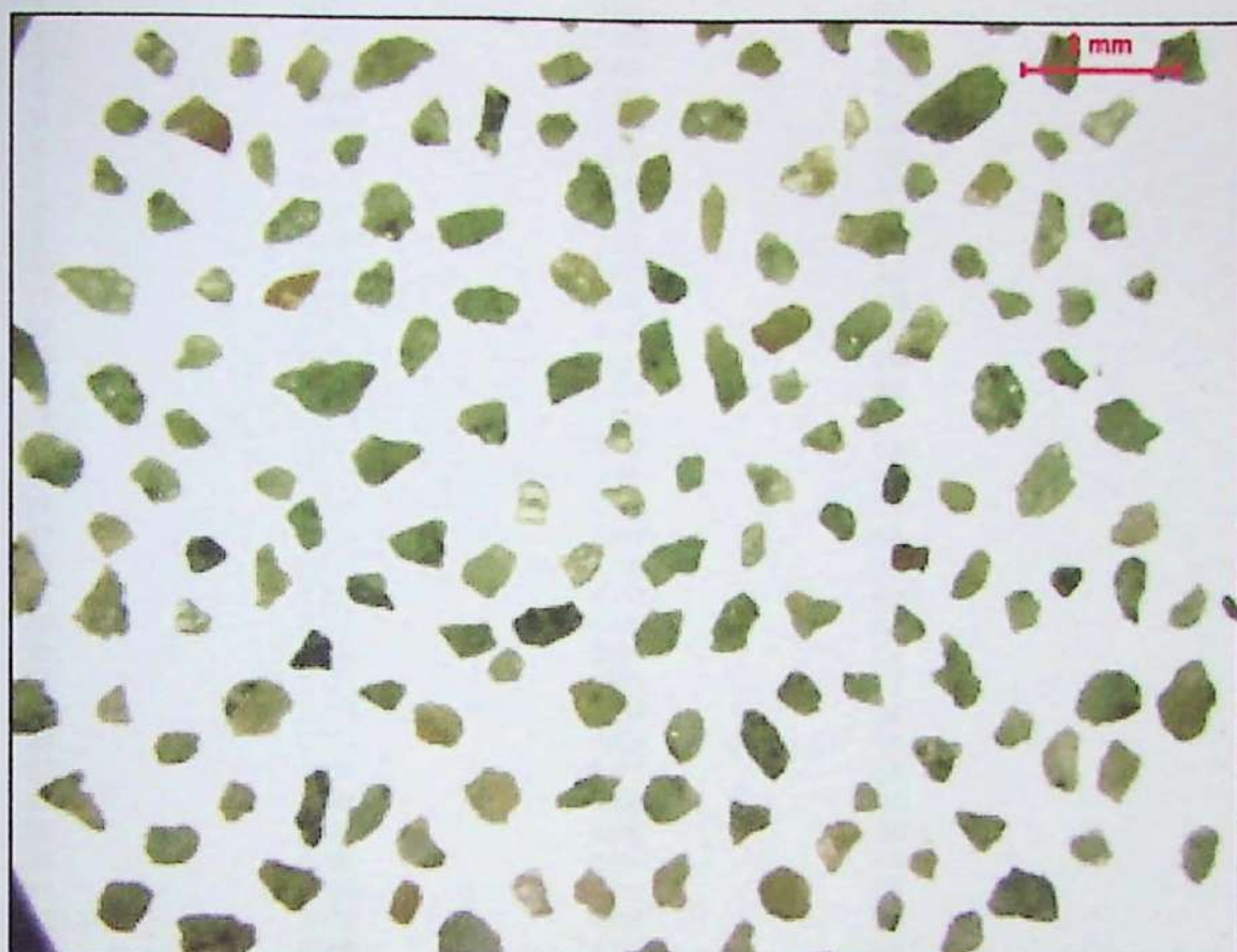
Grãos de areia de britagem de rocha representativos da malha #48 (0,3mm)
