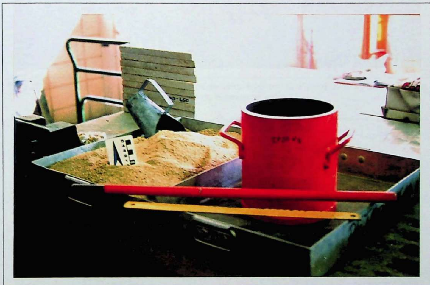
Foto 24. Ensaio para determinação do índice de forma e textura dos grãos. Materiais utilizados.
