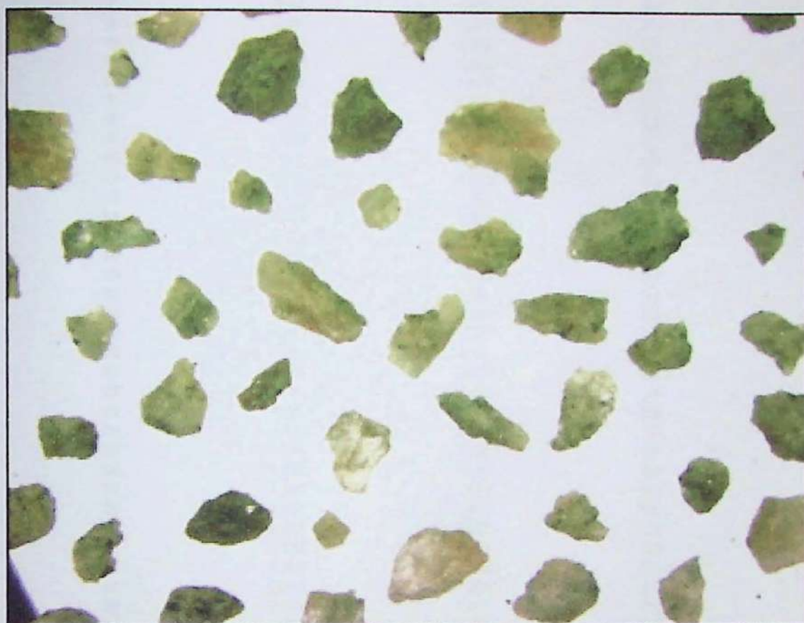
Grãos de areia de britagem de rocha representativos da malha #28 (0,6mm)
