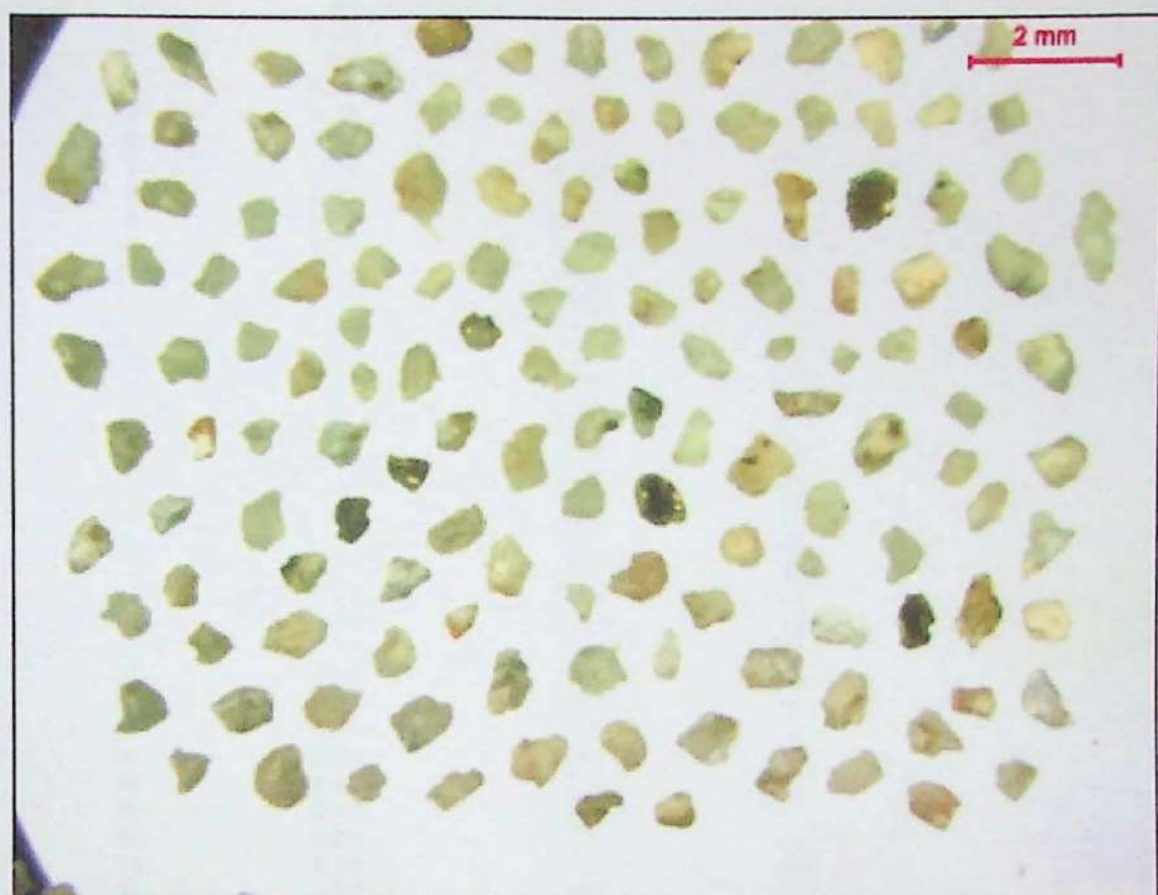
Grãos de areia de desmorte hidráulico representativos da malha #48 (0,3mm)
