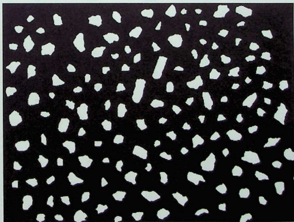
"Imagem binário" obtida a partir dos grãos de areia de desmonte hidráulico malha #100 (0,15mm)
