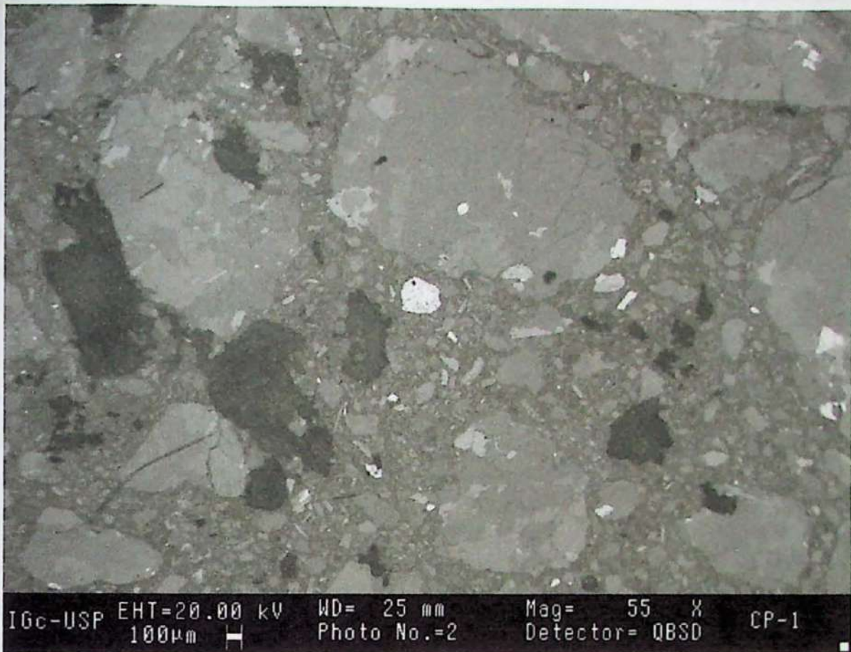
Figura 28. Argamassa elaborada com areia de britagem de rocha. Aumento de 55 vezes. Observar a forma dos grãos, a distribuição granulométrica e o seu envolvimento pela massa de cimento.
