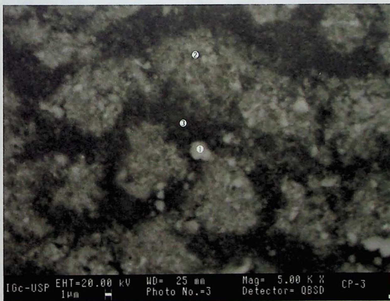
Figura 30. Massa de cimento da argamassa elaborada com areia de leito de rio. Aumento de 5.000 vezes. Observar microcristalização de silicato de cálcio no ponto 1.
