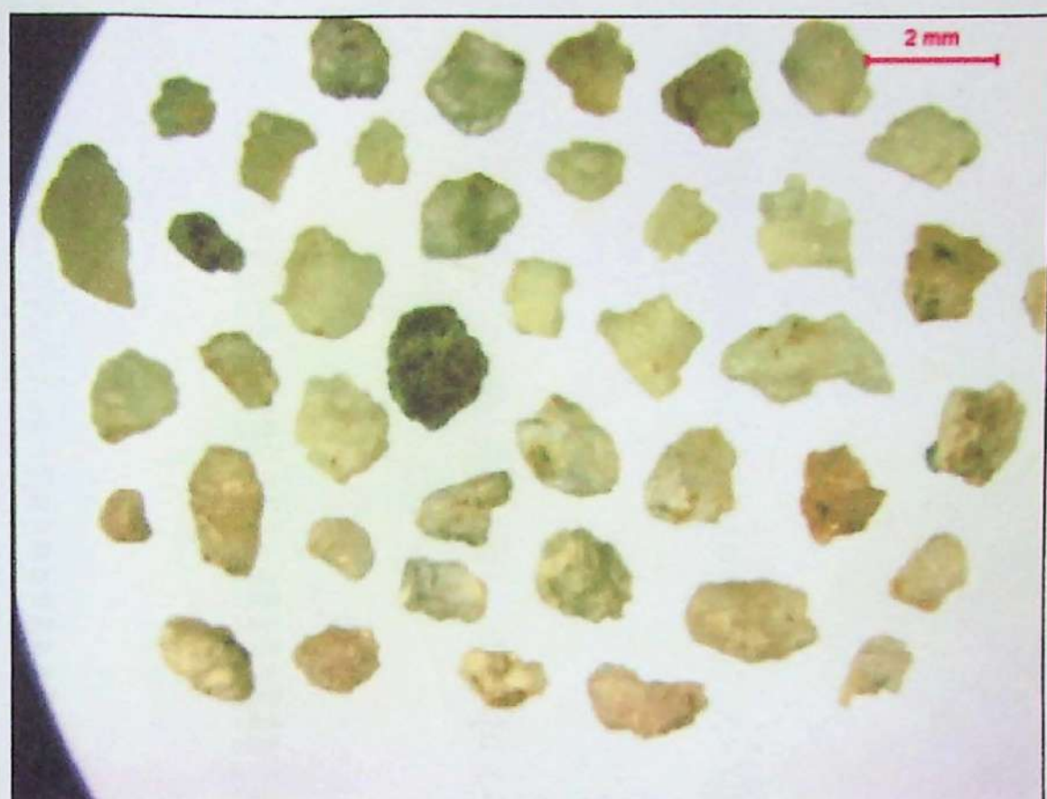
Grãos de areia de desmonte hidráulico representativos da malha #28 (0,6mm)
