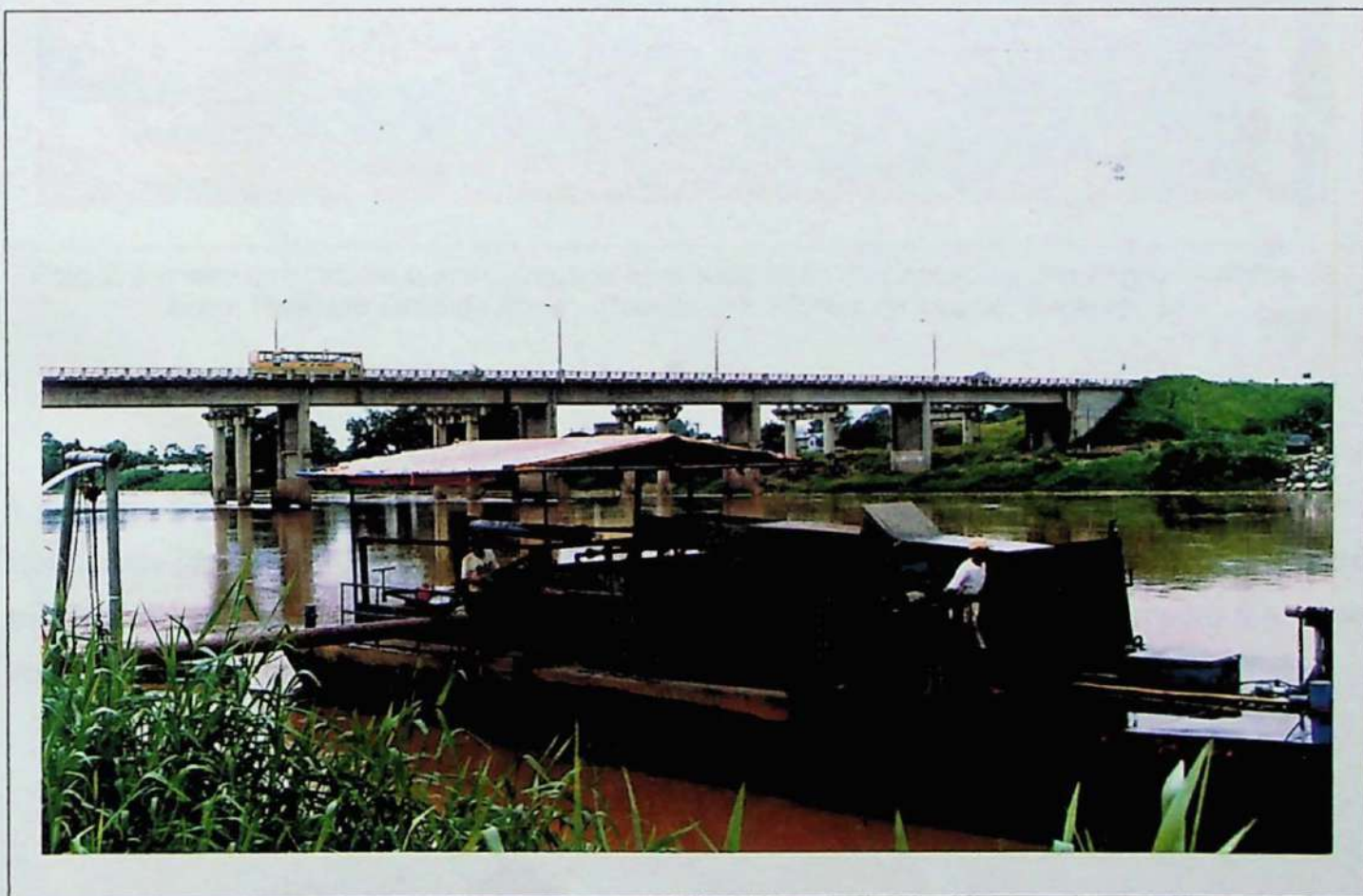
Foto 1. Draga flutuante para extração de areia aluvionar. Ponte de Registro, Rio Ribeira de Iguape, Registro, SP.
