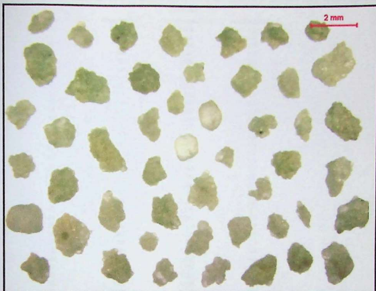
Grãos de areia de moagem de quartzo representativos da malha #28 (0,6mm)
