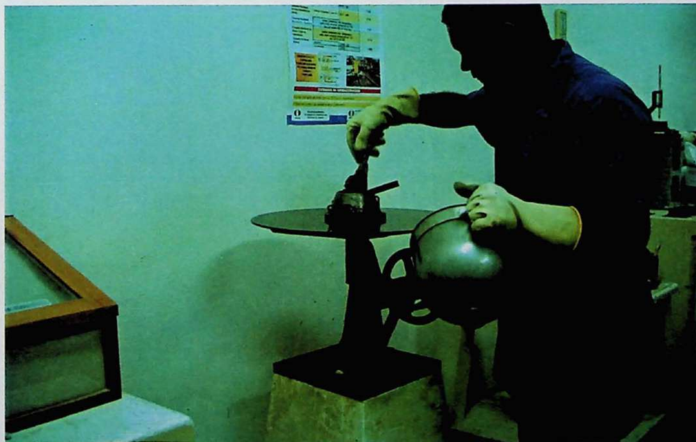
Foto 12. Determinação da consistência da argamassa. Preenchimento do cone para execução de ensaio na "flow table".
