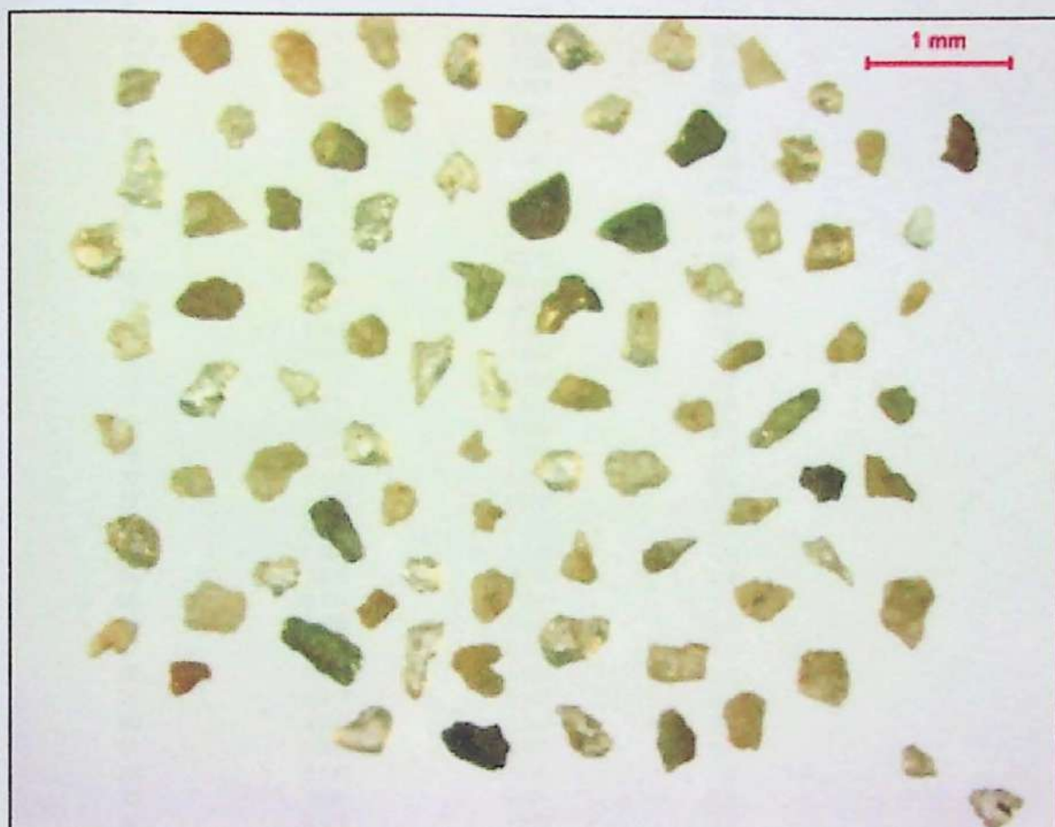
Grãos de areia de leito de rio representativos da malha #100 (0,15mm)
