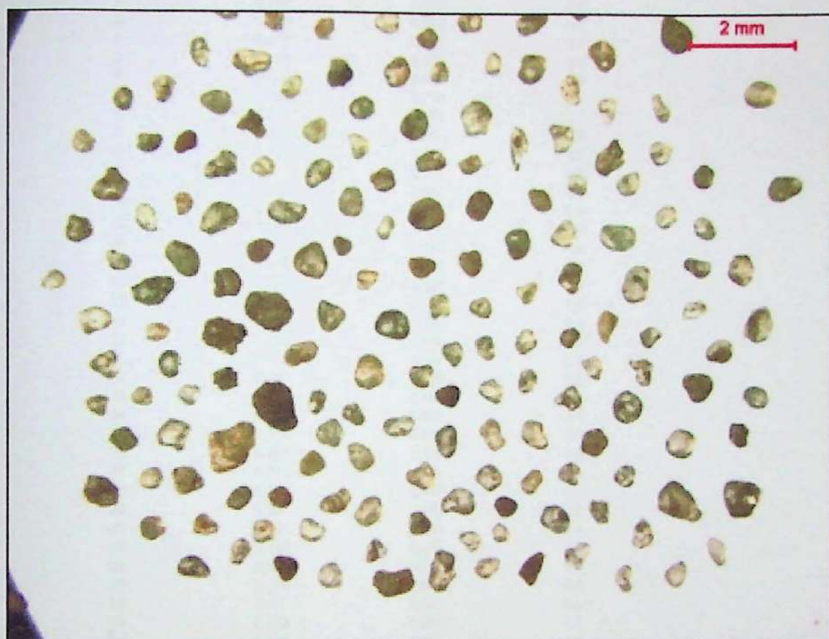
Graos de areia eólica representativos da malha #48 (0,3mm)
