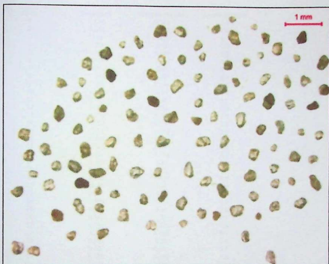
Grãos de areia eólica representativos da malha #100 (0,15mm)
