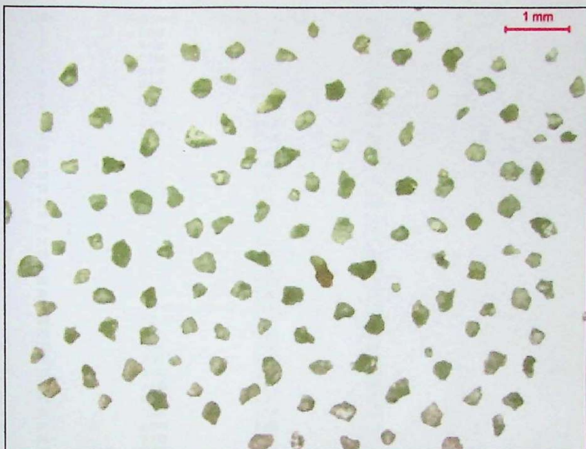
Grãos de areia de moagem de quartzito representativos da malha #100 (0,15mm)
