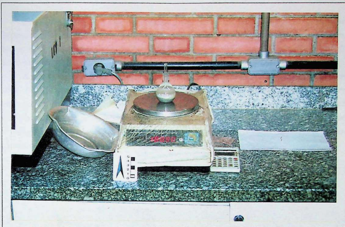
Foto 23. Ensaio para determinação de densidade real. Piquinômetro sendo pesado com amostra de areia e água.
