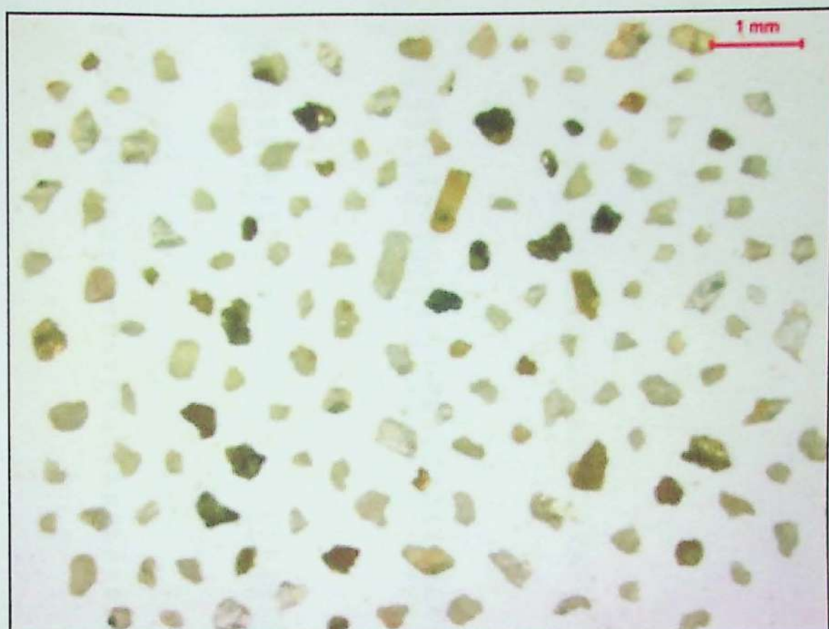
Grãos de areia de desmonte hidráulico representativos da malha #100 (0,15mm)
