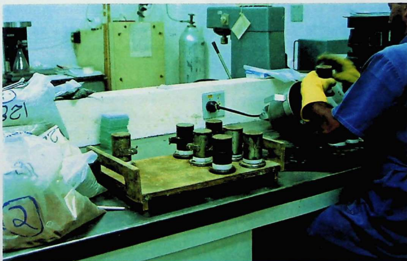
Foto 16. Moldagem dos corpos de prova. Retirada do excesso de massa dos moldes para uniformidade da superfície dos corpos de prova.
