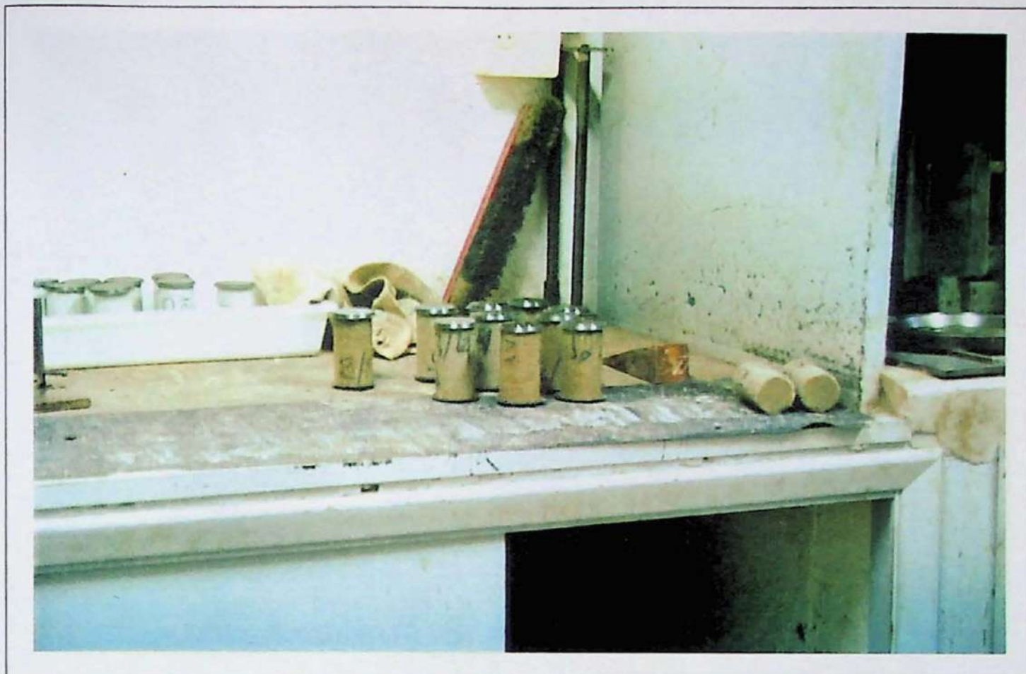
Foto 19. Corpos de prova já capeados com enxofre em suas extremidades.
