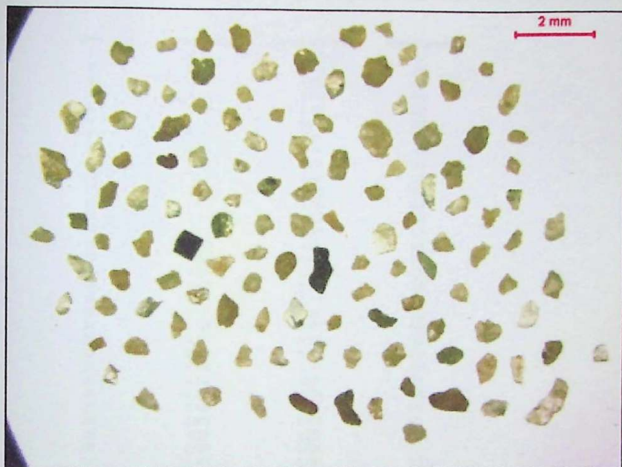
Grãos de areia de leito de rio representativos da malha #48 (0,3mm)
