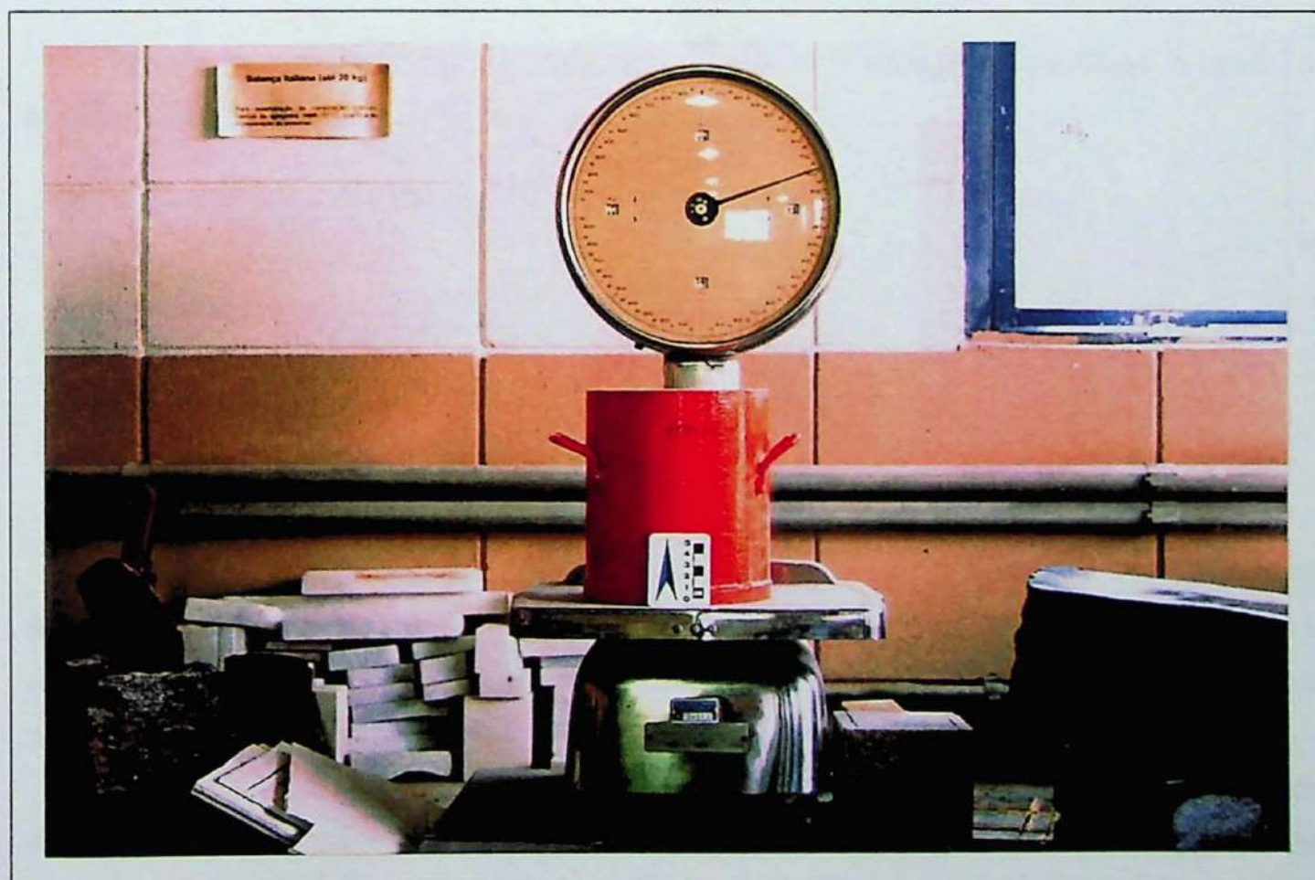
Foto 26. Ensaio para a determinação do índice de forma e textura dos grãos. Pesagem do cilindro, depois de rasado.
