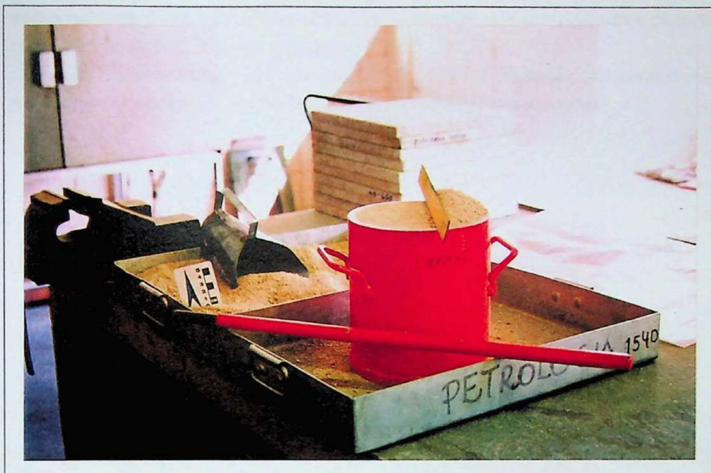
Foto 25. Ensaio para a determinação do índice de forma e textura dos grãos. Cilindro sendo rasado para retirada do excesso de areia.
