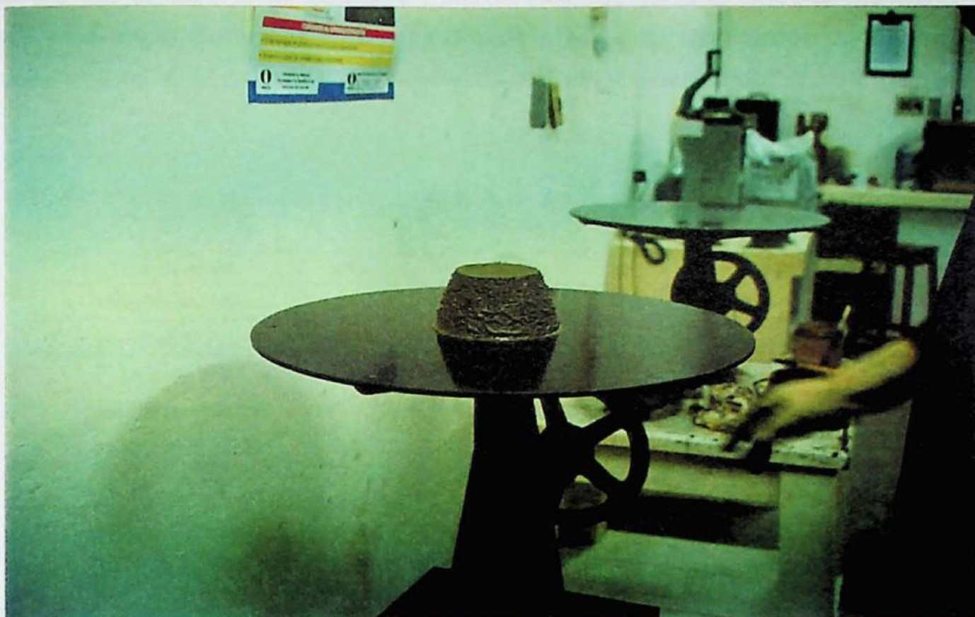
Foto 13. Determinação da consistência da argamassa, logo após retirada do cone.
