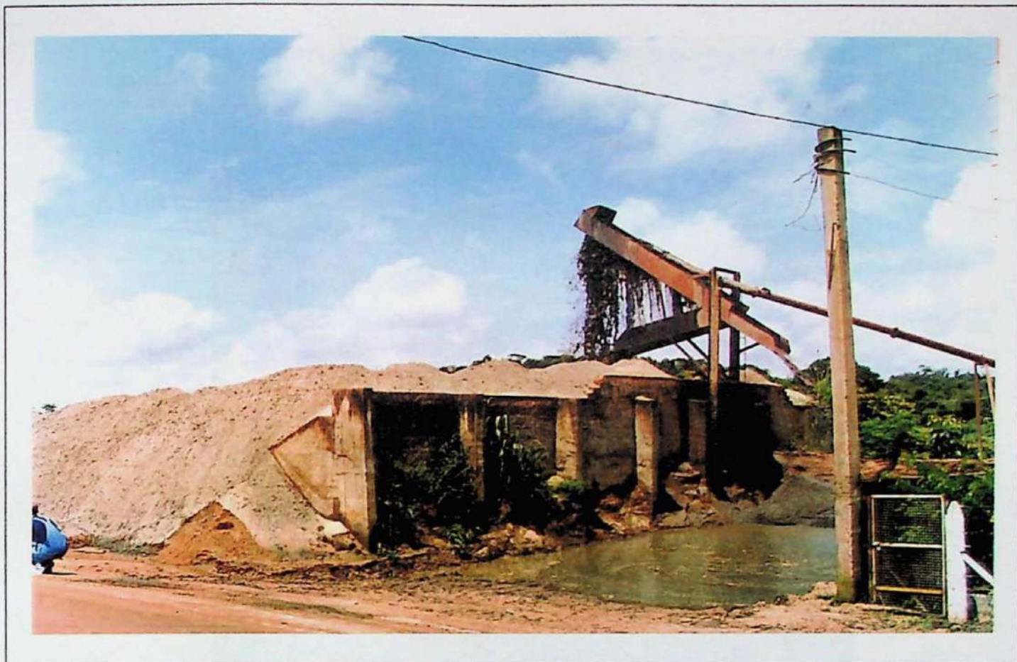
Foto 2. Peneira que recebe a areia dragada para separação do pedrisco e da matéria orgânica da areia. Pirâmide Grão de Areia – Peixoto. Rio Ribeira de Iguape, Registro, SP.
