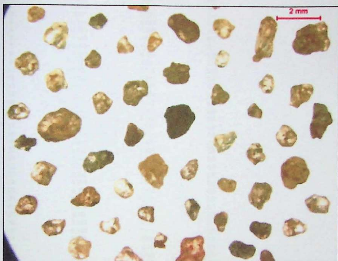
Grãos de areia eólica representativos da malha #28 (0,6mm)
