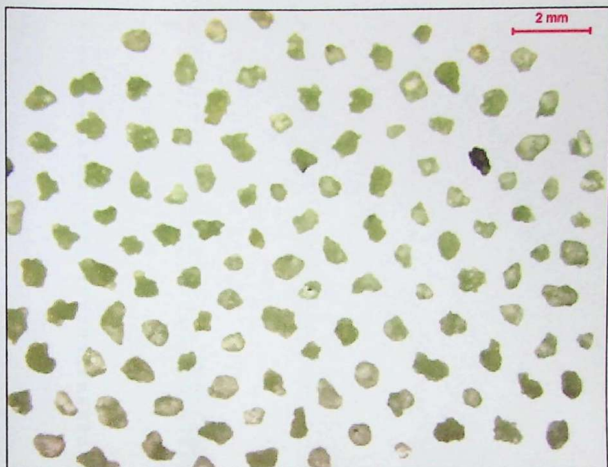
Grãos de areia de moagem de quartzito representativos da malha #48 (0,3mm)
