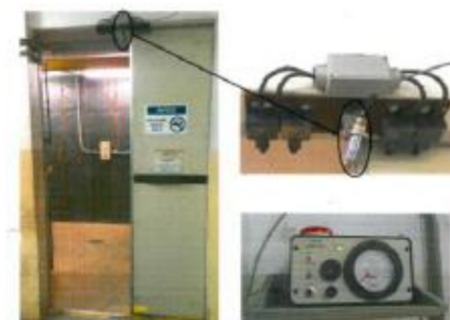
Figura 16 – Medidor de radiação permanente sobre a porta do bunker 2
