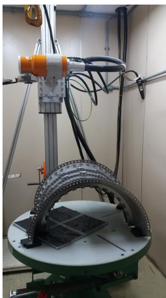
Figura 4 – Operação equipamento de raio-X – Isovolt Titan
