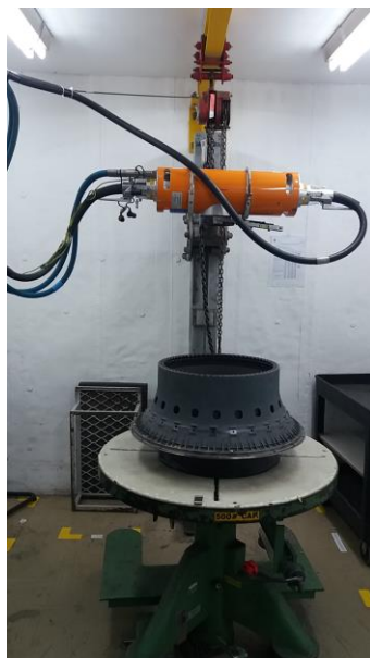
Figura 3 – Operação equipamento de raio-X – Isovolt Titan E
