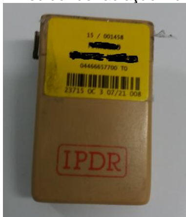
Figura 7 – Medidor de radiação individual
