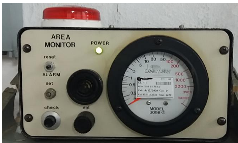
Figura 8 – Monitor de radiação de área
