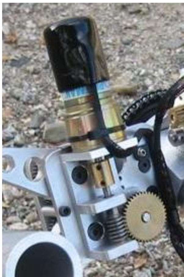
Figura 30 – Mecanismo de transmissão utilizado pela SWAT
