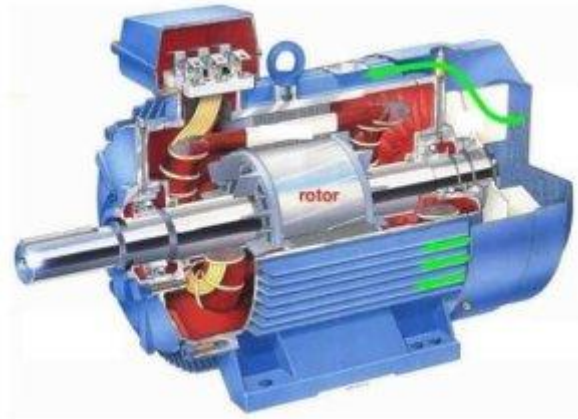
Figura 12 – Esquema de motor AC
