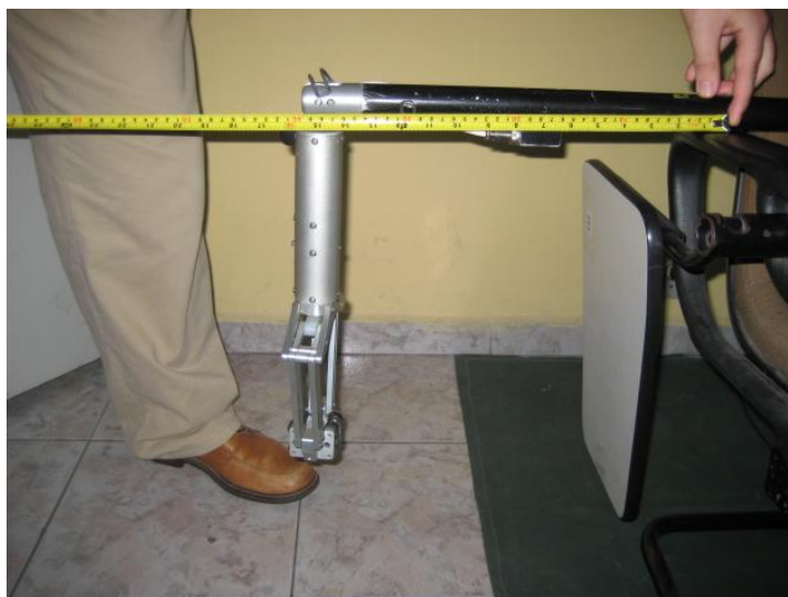
Figura 29 – Ajuste de ângulo de ação da pinça
