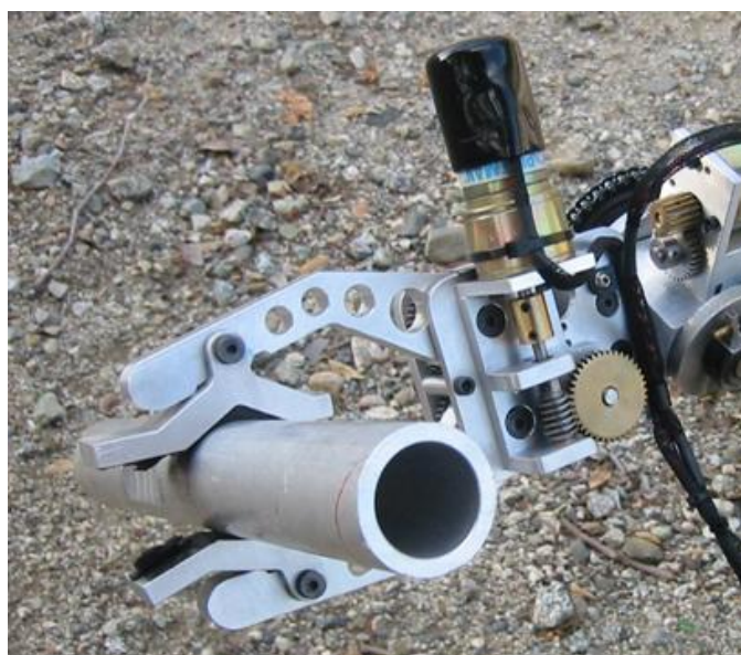
Figura 7 – Garra de pinças simétricas acionadas por motor CC
