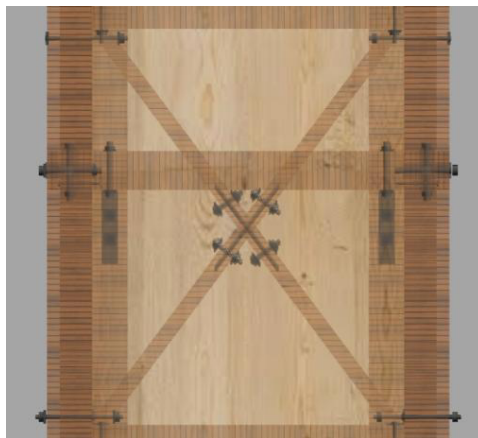
Figura 65 - Contraventamento em x transparente.
