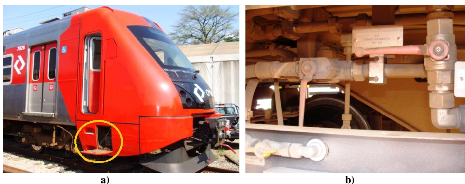
Figura 35: a) posição da torneira de reboque por locomotiva e b) detalhe da torneira.
