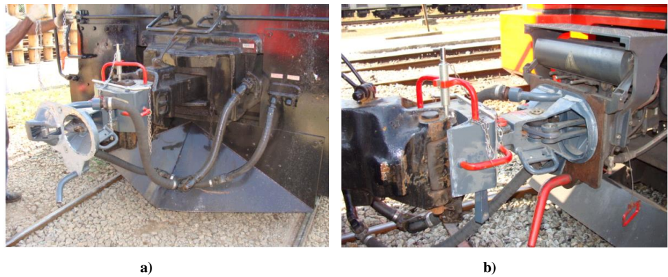
Figura 12: Adaptador de Engate Automático para Locomotiva – a) desacoplado e b) acoplado.
