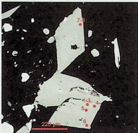
Figura 3-14: (A) Imagem BSE-Compo destacando titanita da amostra PPE-8A, nefelina sienito médio-grosso a grosso, com a localização dos pontos analíticos. (B) Diagrama mostrando a variação química em c.p.f.u. entre os pontos analisados.
