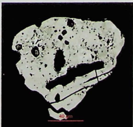
Figura 3-19: Imagens BSE-Compo com destaque para as magnetitas do enclave Tipo I. (A) da borda do enclave (amostra PPE-7Aa), (B) da matriz do enclave (amostra PC-19) e (C) opaco incluso no diopísio titanífero (amostra PPE-1Bg).
