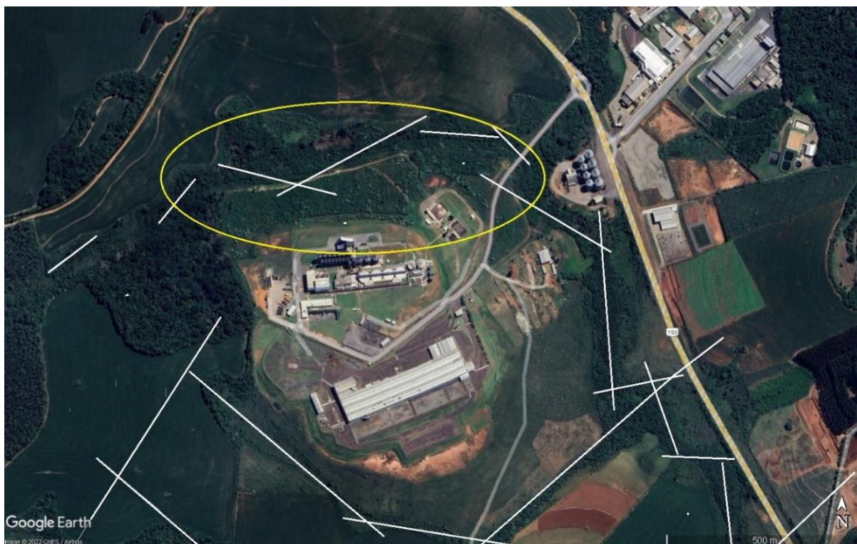
Figura 2 – Localização da área em que foram feitos os levantamentos de eletrorresistividade (elipse amarela), com as interpretações dos lineamentos marcadas (retas brancas). Nota-se que as principais estruturas estão aproximadamente em direção NE e NW (Google Earth).
