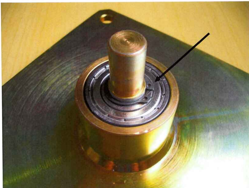
Figura 38 - Detalhe de montagem do anel de retenção
