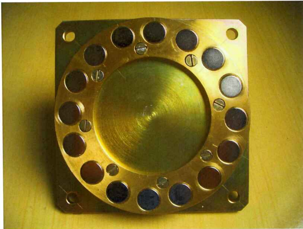
Figura 37 - Montagem de um dos rotores do acoplamento magnético
