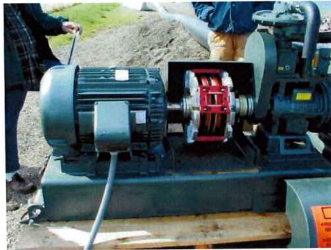
Figura 8 - Exemplo de aplicação do acoplamento magnético: bombas para irrigação
