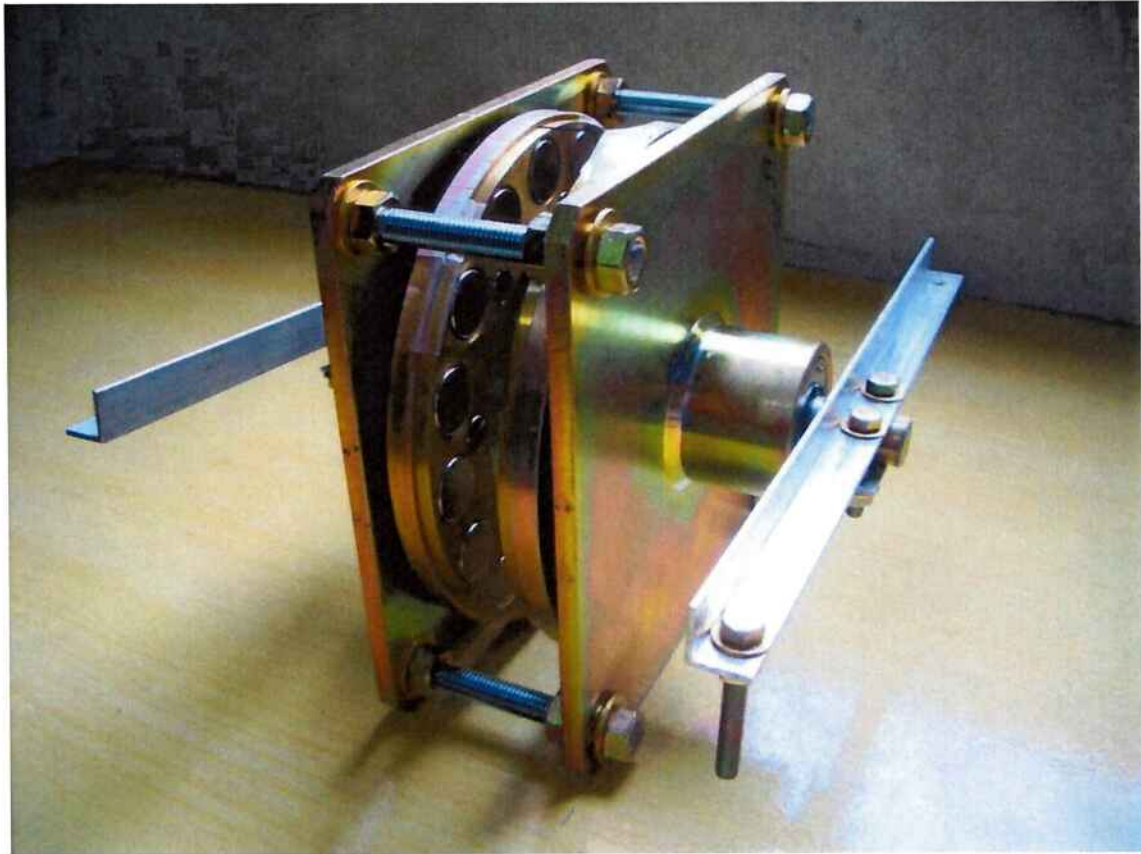
Figura 43 - Arranjo completo do acoplamento para as medições
