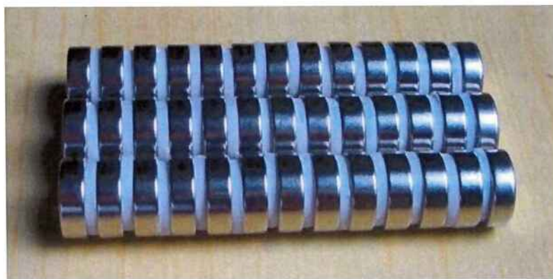
Figura 35 - Ímãs de neodímio empregados no acoplamento magnético
