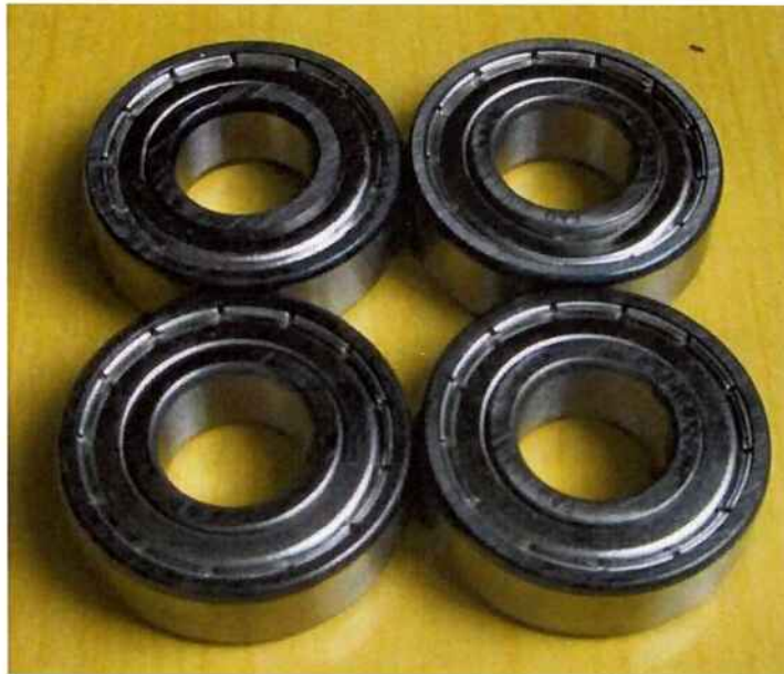
Figura 36 - Rolamentos utilizados no acoplamento magnético
