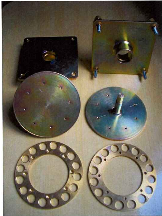
Figura 34 – Peças fabricadas do acoplamento magnético
