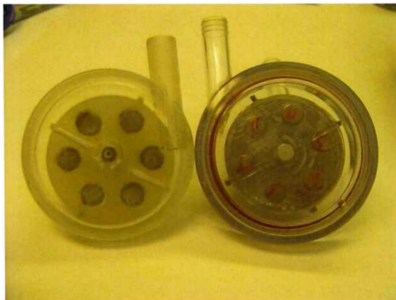
Figura 13 - Exemplo de aplicação do acoplamento magnético: bomba artificial para o coração humano
