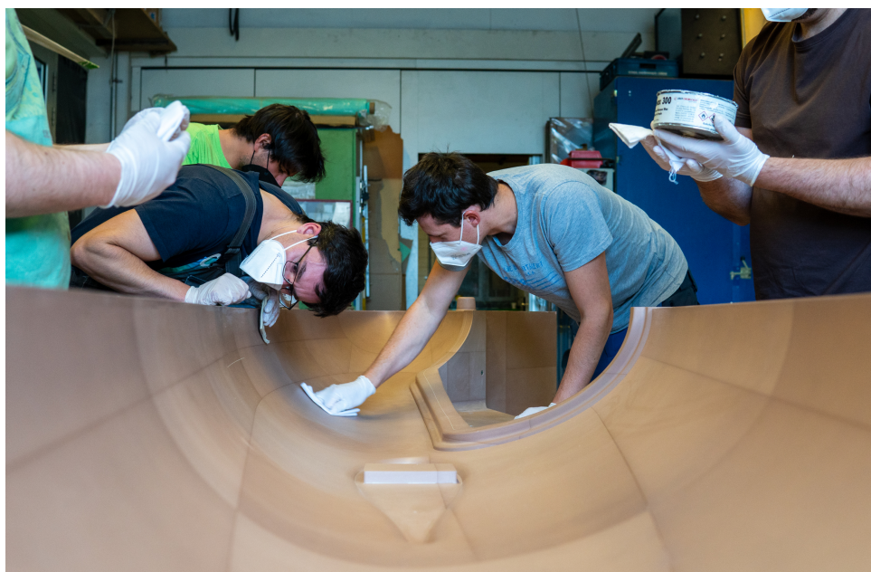
Figura 34 – Membros da Akaflieg München preparando um molde negativo de fuselagem. Foto por Eirik Albretsen. Fonte: Akaflieg München e. V.
