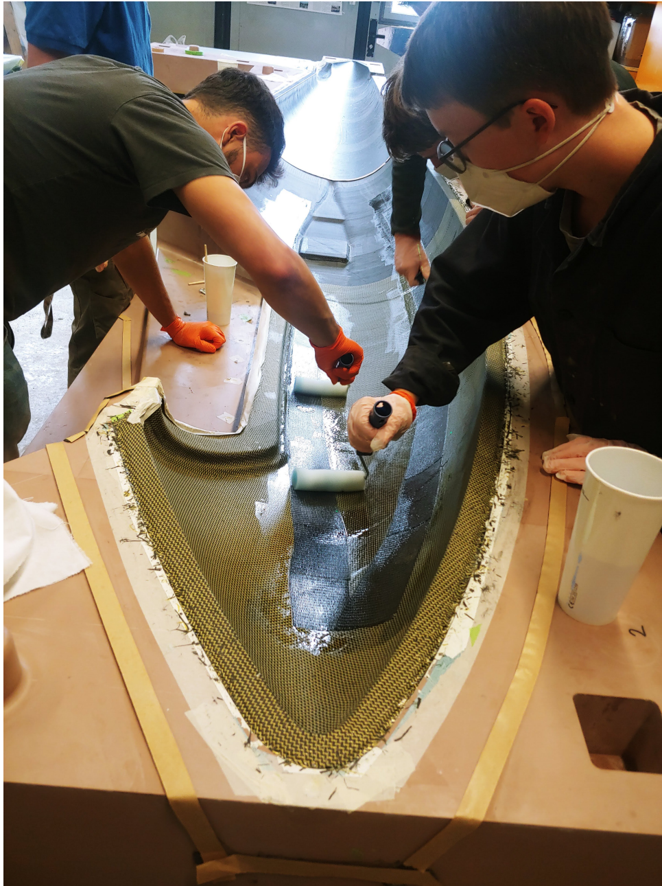
Figura 38 – Processo de laminação da fuselagem do Foto por Joscha Löwe. Fonte: Akaflieg München e. V.
