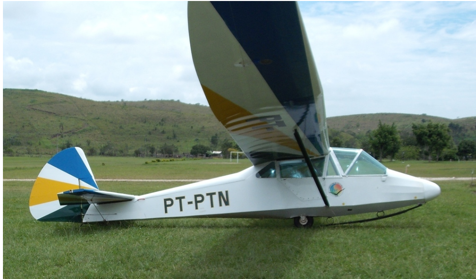
Figura 4 – Neiva B Monitor, um exemplo de planador construído em estrutura tubular treliçada metálica e revestido em tela. Fonte: Sérgio Lousada Jr. via Wikimedia Commons
