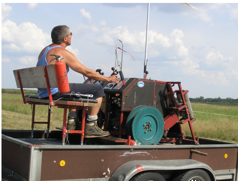
Figura 18 – Exemplo de guincho utilizado para o lançamento de planadores. Fonte: Kai-Martin Knaak via Wikimedia Commons
