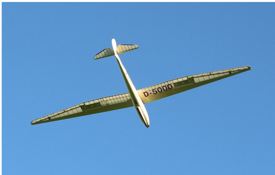
Figura 2 – Condor IV, exemplo típico de um planador dos anos 1930. Note a estrutura da asa, com um D-Box de madeira no bordo de ataque e revestimento em tela. Fonte: Tobias Knorr via Wikimedia Commons
