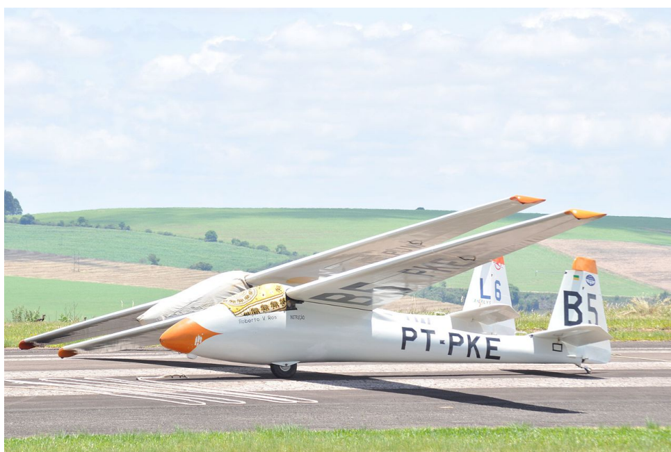
Figura 3 – KW-1 Quero-Quero, um exemplo de planador construído em madeira no Brasil. Fonte: Sérgio Lousada Jr. via Wikimedia Commons
