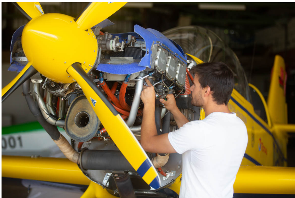
Figura 37 – Um membro da Akaflieg München inspeciona o motor Lycoming AEIO-540 da aeronave acrobática experimental Mü 30. Fonte: Akaflieg München e. V.
