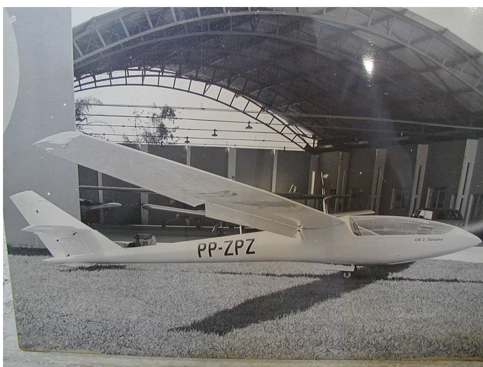
Figura 39 – CB-2 Minuano. Note os flapes e porta do trem de pouso retrátil. Fonte: Paulo Iscold via Wikimedia Commons
