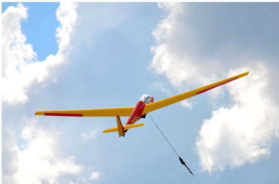
Figura 17 – Um Schleicher ASK-13 sendo lançado por guincho. Note que o cabo está acoplado na posição ventral. Fonte: Olga Ernst via Wikimedia Commons
