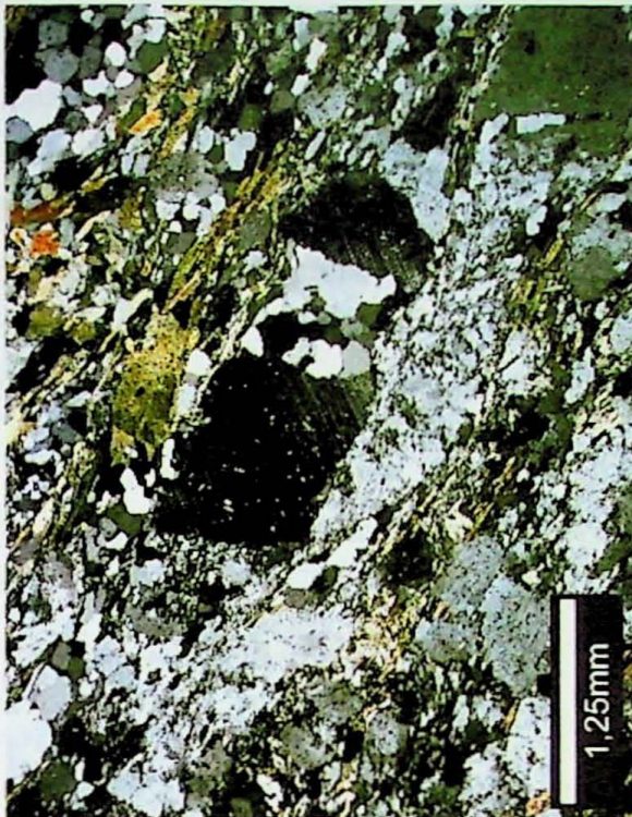
Foto 5: Afloramento MS-135C - fotomicrografia do metaconglomerado polimítico. Detalhe do fragmento de rocha granítica provido do embasamento arqueano TTG.
