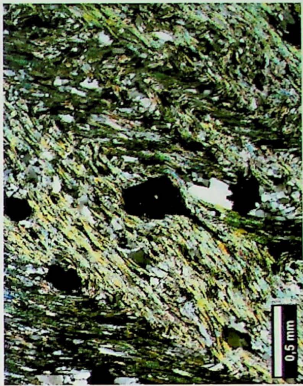
Foto 3: Afloramento MS-125 - fotomicrografia do actinolita-clorita xisto com granada com polarizadores cruzados.
