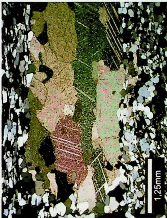
Foto 4: Afloramento MS-135C - fotomicrografia do metaconglomerado polimítico. Detalhe do fragmento de rocha carbonática provido do Sgr. Minas.
