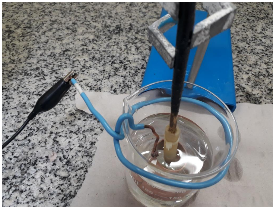
Figura 8 - Visão de cima do béquer da aparelhagem para o método de extração dos precipitados via eletroquímica.
