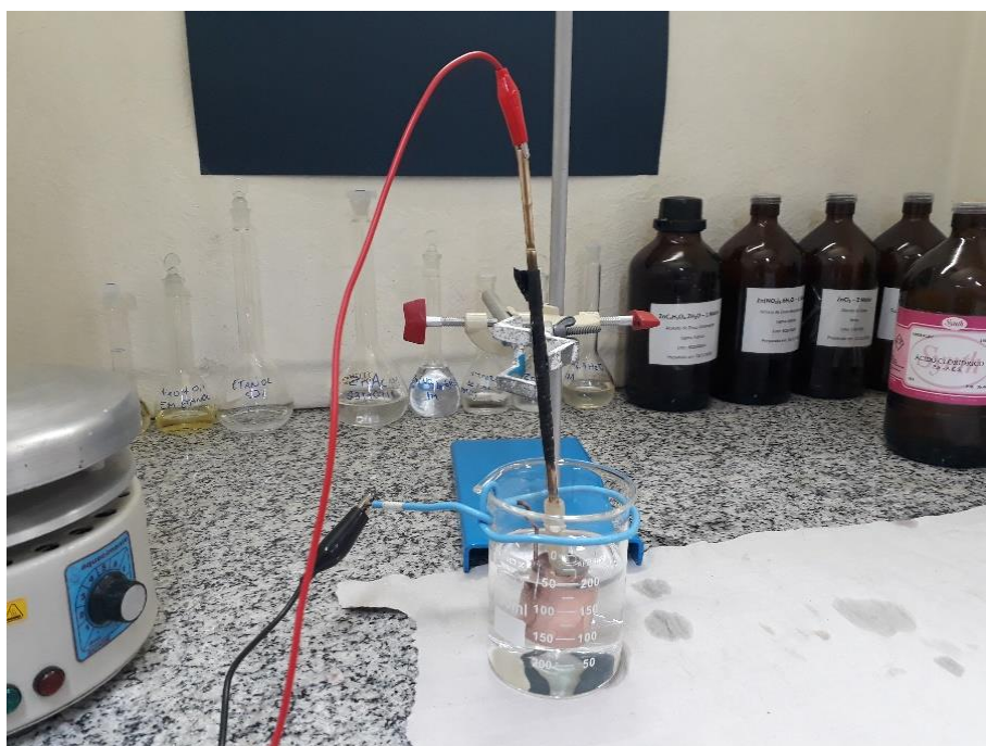
Figura 7 - Visão do b quer da aparelhagem para o m todo de extra  o dos precipitados via eletroqu mica.
