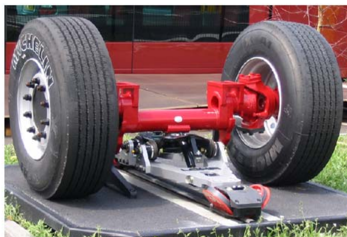
FIGURA 22 – SISTEMA DE GUIAGEM POR TRILHO
