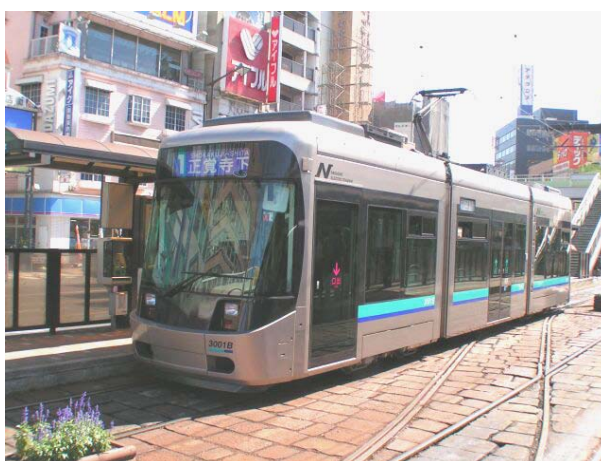
FIGURA 79 - VLT COM PISO REBAIXADO - NAGASAKI - JAPÃO – FONTE: WIKIPEDIA
