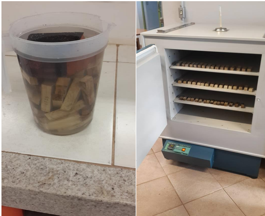
Figura 7: Amostras imersas em água visando a sua saturação (Esq.) e amostras em estufa visando a sua secagem (Dir.). Fonte: acervo pessoal.
