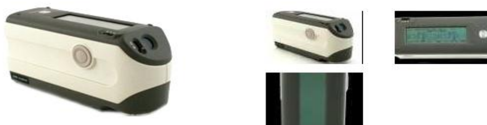
Figura 5: Espectofotometro CM – 2500 D. Fonte: KONICA MINOLTA
