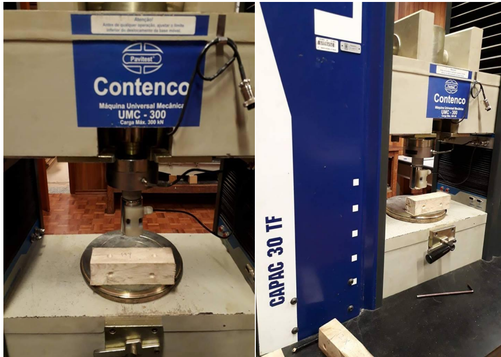
Figura 8: Máquina universal mecânica UMC – 300 CAPAC 30 TF junto com amostra para análise da dureza Janka. Fonte: acervo pessoal.
