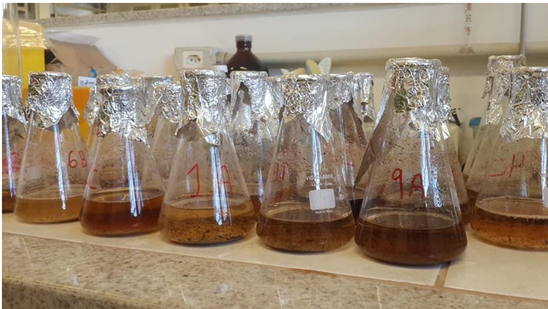
Figura 13: Frascos de Erlenmeyer 100 mL com serragem em água pré-destinadas a irem para banho-maria (água quente). Fonte: Acervo pessoal
