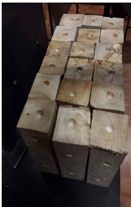
Figura 10: Amostras de dureza após a análise e marca da esfera semi-circular. Fonte: acervo pessoal
