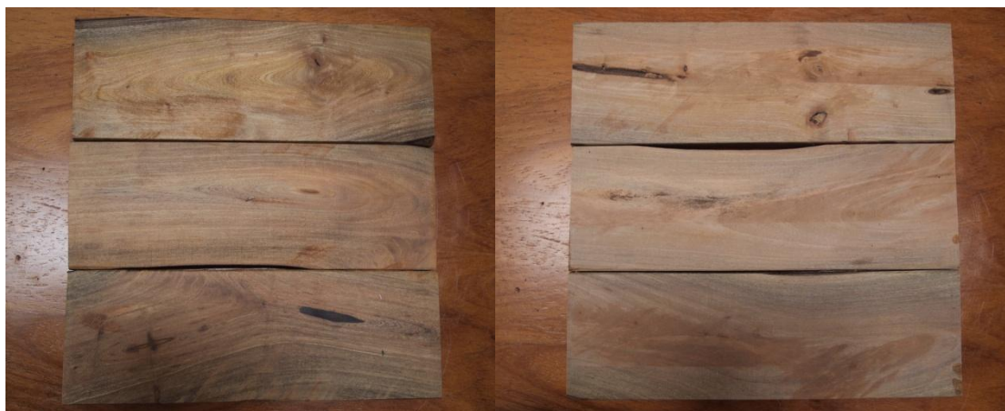
Figura 23: Cor e desenho da madeira residual da espécie Ipê-rosa; em verniz (Esq.) e sem verniz (Dir.)
