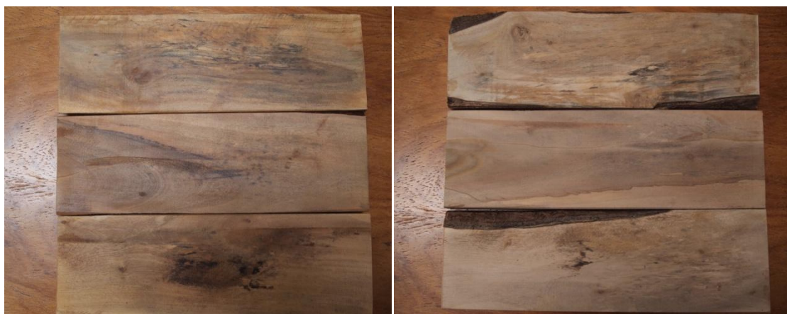
Figura 22: Cor e desenho da madeira residual da espécie Aroeira-salsa; em verniz (Esq.) e sem verniz (Dir.)
